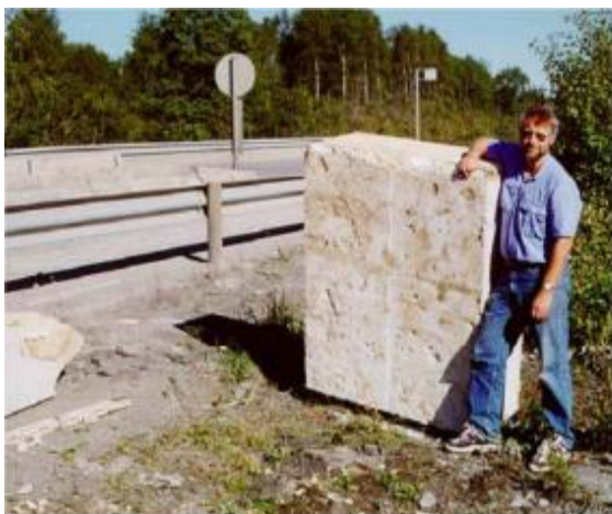
Figur 23. Bilde fra «keynote» presentasjon med forfatteren og en blokk av den første EPSfyllingen på Rv 159 Flom bruer. Foto Tor Helge johansen
