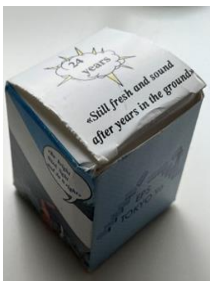
Figur 13. Testtetteringer fra den første EPS fyllingen i Norge (Flom bruer). Foto: R. Aabøe, SVV
