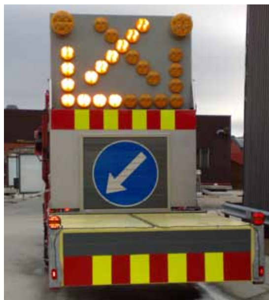
Figur 4.3 Varselpanel på motorkjøretøy med støtpute.
