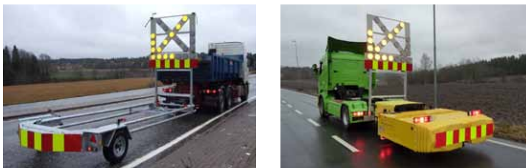
Figur 4.12 Energiabsorberende utstyr på kjøretøy (eksempler).
