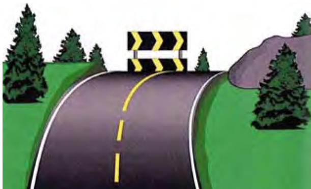
Fig. 33 Eksempel på bruk av bakgrunnsmarkering i kurve skjult bak høybrekk
