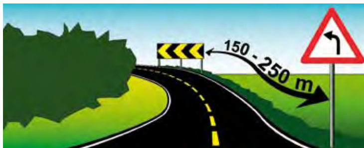
Fig. 3 Normal forvarslingsavstand for fareskilt ved fartsgrense høyere eller lik 70 km/t
