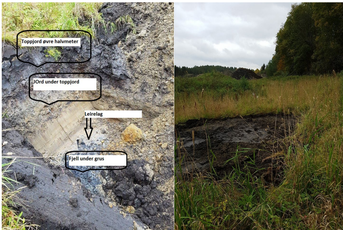
FIGUR 28. PRØVEGROP DER TRE JORDPRØVER BLE TATT UT I ULIKE LAG. BILDET TIL VENSTRE VISER JORDPROFILET DER DET BLE TATT UT PRØVER. BILDET TIL HØYRE VISER OMRÅDET FOR UTTAKET AV JORDPRØVER, SOM LÅ OPPSTRØMS OMRÅDET FOR MELLOMLAGRING AV ALUNSKIFER. FOTO: HALDIS FJERMESTAD
