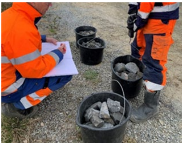
FIGUR 18. DET BLE UTFØRT STIKKPRØVEKONTROLLER UNDERVEIS I KNUSE- OG SIKTEPROSESSEN. FOTO: CECILIE HALLINGSTAD
