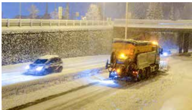
E6 Omkjøringsvegen i Trondheim. Brøytebil med plog og saltspreder. Foto Knut Opeide
