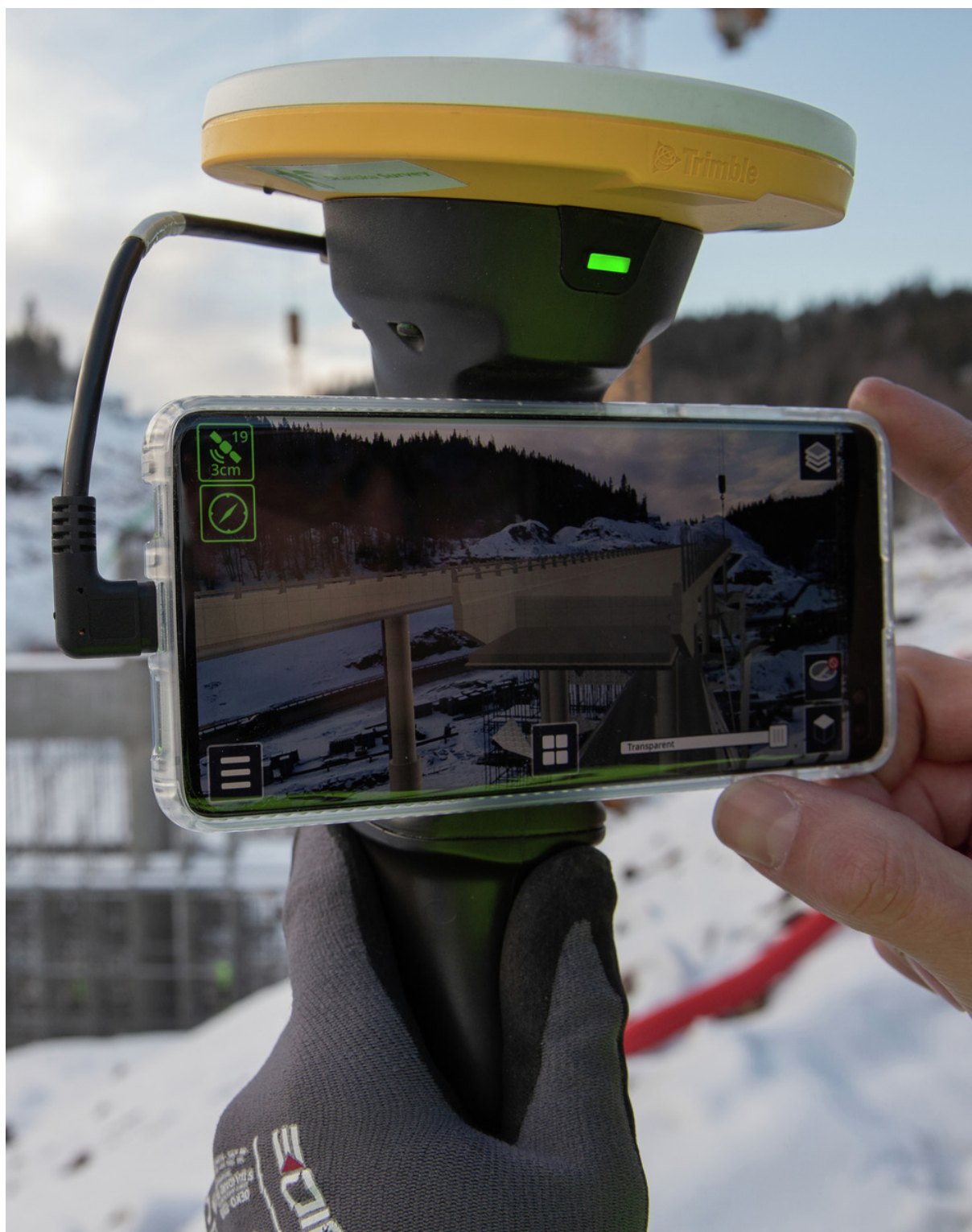
Trimble SiteVision brukes på anlegget E16 Sandvika-Skaret for å sjekke at alt er gjort riktig. 3D-modellen viser byggearbeidet i samtid. Foto: Red Ant, Statens vegvesen
