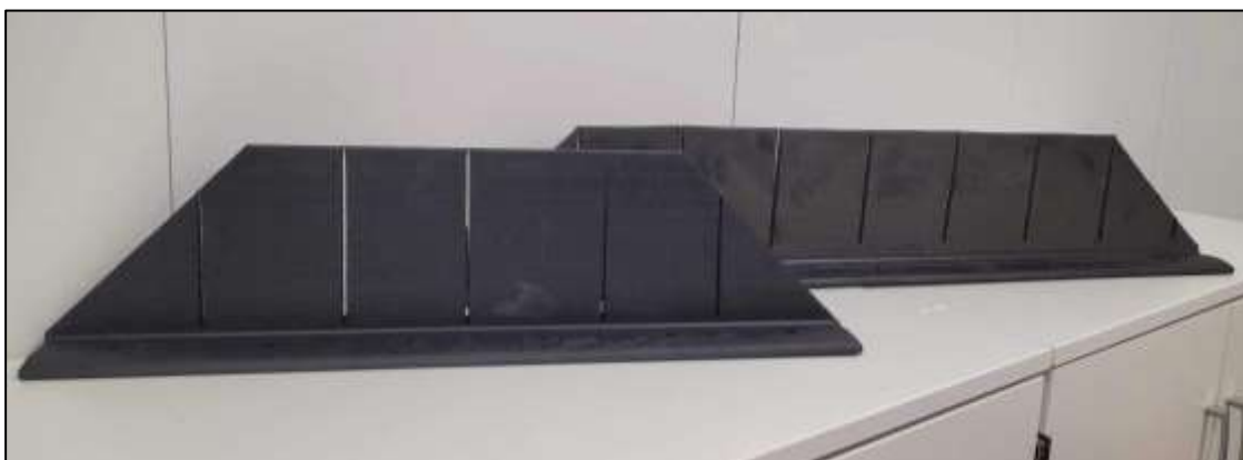
Figur 64. Fleksiterskler av ulik størrelse, 60 cm (venstre) og 90 cm (høyre). Vanligvis så brukes fleksiterskler på 90 cm lengde i 1500 mm kulverter og oppover (Foto: Thomas Ruud, Sweco).
