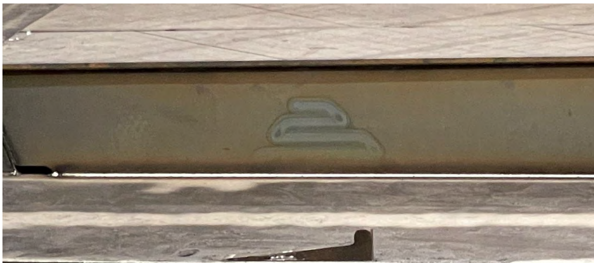
Figur 27 Laser Hybrid sveis med full gjennombrenning
