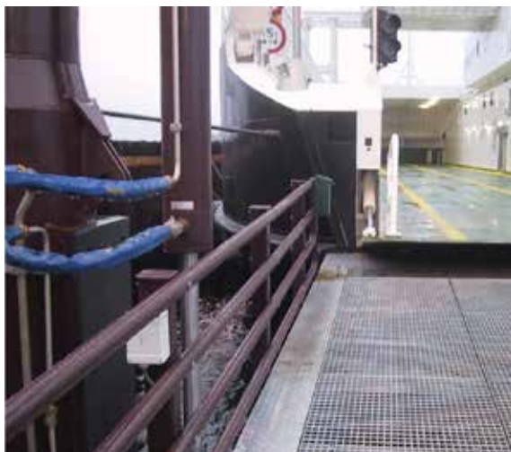
Figur 11: Bildet viser indikator på rekkverksstolpe
