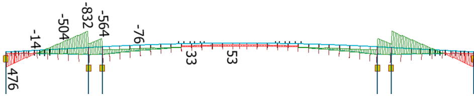
Figur 9.47: Momentdiagram - Svinn [kNm].
