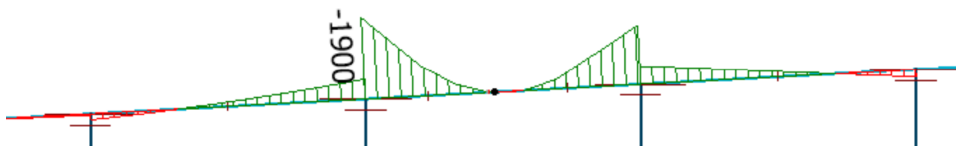
Figur 9.7: Momentdiagram - Maksimalt støttemoment i akse 7 [kNm]. Her er det dobbel kjøretøylast på utkrageren.
