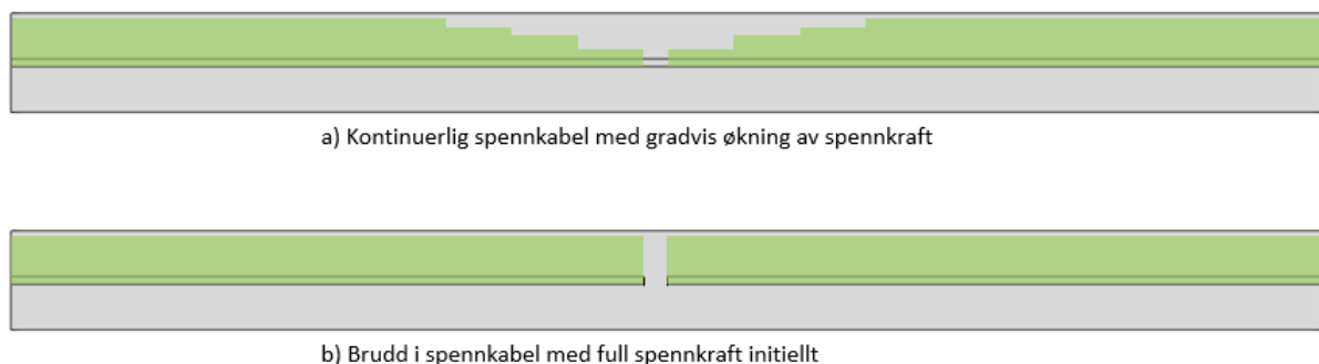
Figur 8.18 - Ulik forspenning av kablene ved de to måtene å simulere brudd
