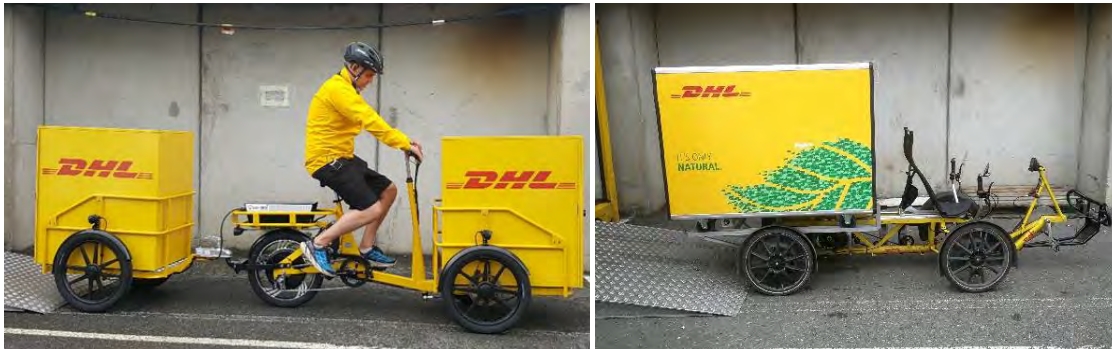
Figur 4-4.: Lastesyklene brukt av DHL i pilotprosjektet. Fotos: TØI. (Ørving mfl. 2020).
