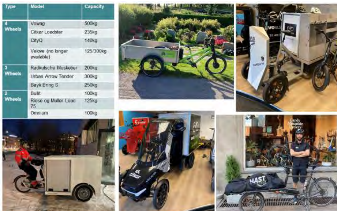
Figur 4-2.: Utvalg av lastesykler brukt i Oslo. Radkutsche Musketier, Vowag (øverst) Urban Arrow, Citkar, Omnium (nederst). Foto: Howard Weir. (Ørving og Weir, 2022).
