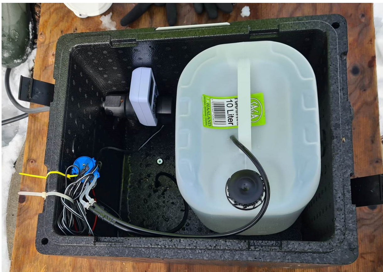
Figur 8. Pumpe med elektronisk timer for å få pumpen inn metanol, 9 ganger per døgn og stå på i 7 min hver gang, inn i F1. Kanna inneholder 10 liter med metanol og ved tom blir fylt på. Boksen vil bli lukket igjen og det har blitt båret hull for å sikre luftgjennomstrømning. (foto: Manh-Tien Bui).
