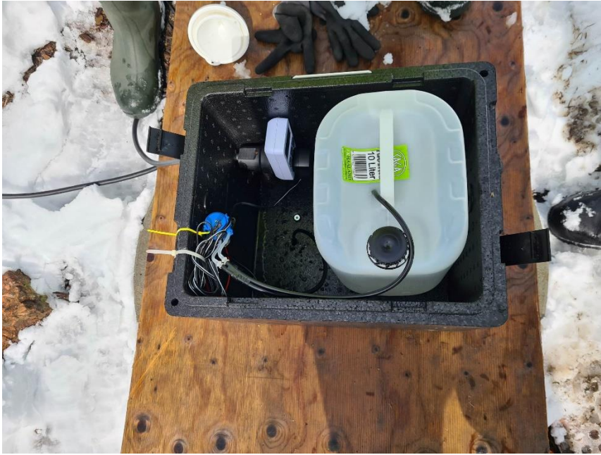
Figur 13. Bilde av isolert boks med pumpe, timer og beholder med metanol (bilde, Manh – Tien Bui).
