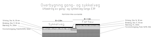
Figur 52: Overbygning GS-veg, utklipp F-tegning
