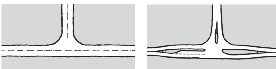
Figur 19: Ukanalisert T-kryss og kanalisert kryss [53].
