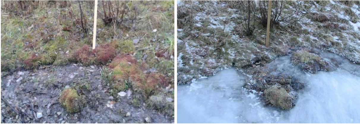
Figur V- 19a) Detaljbilde av en av stikkene. Foto: A. Liereng (5.11.15) b) Samme sted. Iskjøving begynner der grunnvannet kommer fram i bunnen av skråningen. Foto: A. Liereng (15.1.16)
