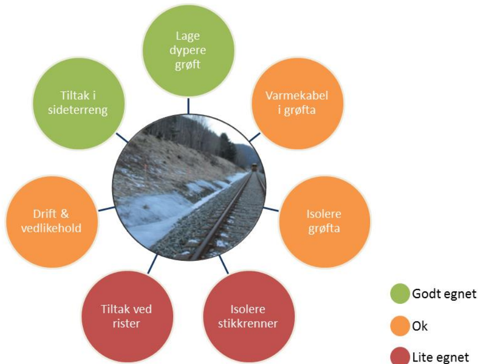
Figur 104) Anbefalte strategier der iskjøving fra sideterreng fyller grøfta med is fra siden.
