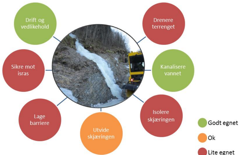
Figur 96) Anbefalte strategier for å forebygge iskjøving i bekker som føres ned over skjæringer.
