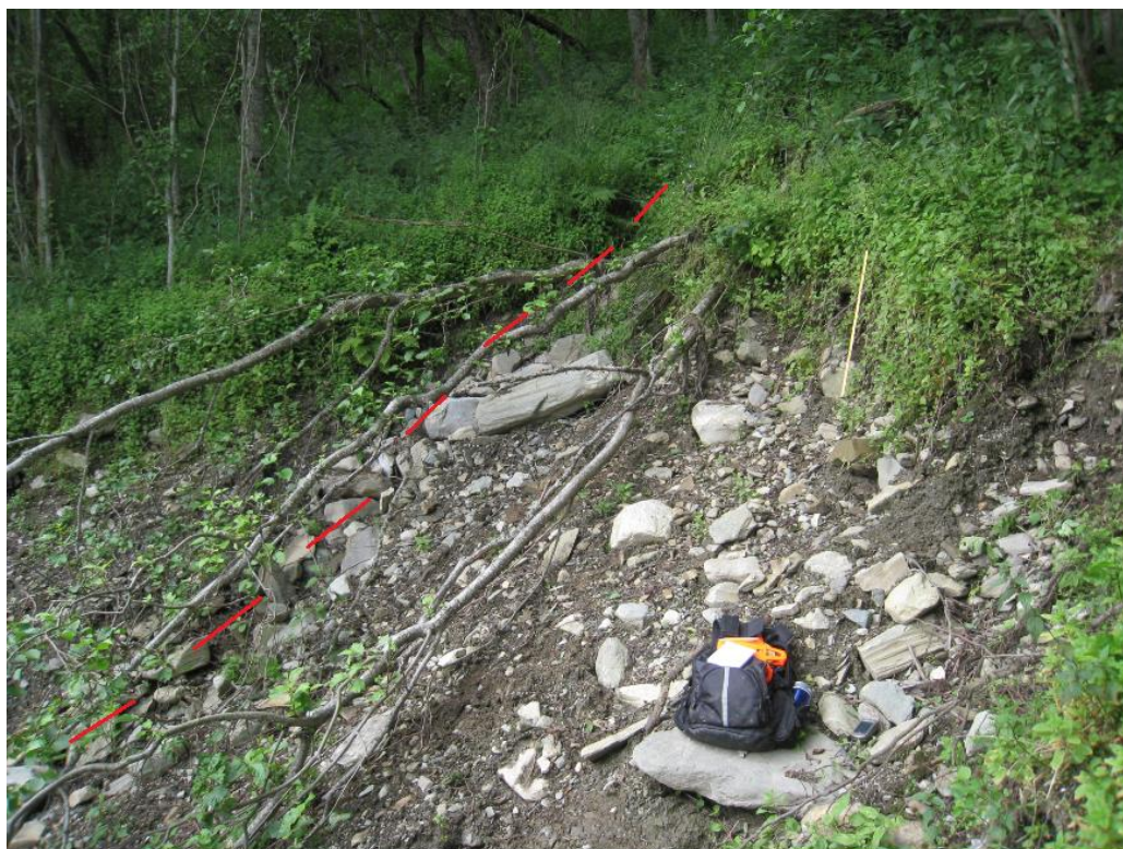
Figur 5.23 Utløsningsområde 2 i skred 3. Dybden til skredsåret varierte fra ca. 40 – 80 cm. Rød stiplet linje markerer hvor det dypere partiet med spor etter rennende vann hadde sitt utløp ut i overkant av utløsningsområdet. Gul tommestokk på bildet tilsvarer 80 cm. Foto: Daniel Haugen Edvardsen.
