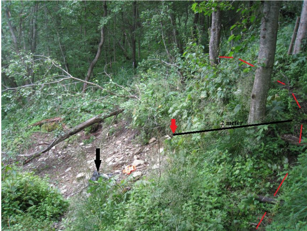
Figur 5.21 Beliggenheten til utløsningsområde 1 i forhold til stien som ligger ca. 2 meter i bakkant av skredsåret (markert med rød stiplet linje). Rød pil markerer øverste del av skredsåret, mens svart pil viser sekk som er målestokk. Foto: Daniel Haugen Edvardsen.
