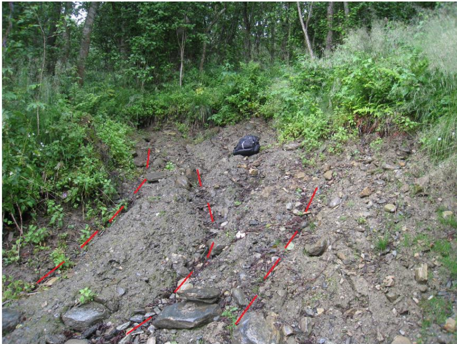
Figur 5.42 Bilde av utløsningsområde 1 i skred 4. Røde stiplede linjer markerer dypere spor etter rennende vann i løsmassene innad i utløsningsområdet. Bredden til lokaliteten ble målt til ca. 4 meter, og hadde en helningsvinkel på ca. 30°. Foto: Daniel Haugen Edvardsen.
