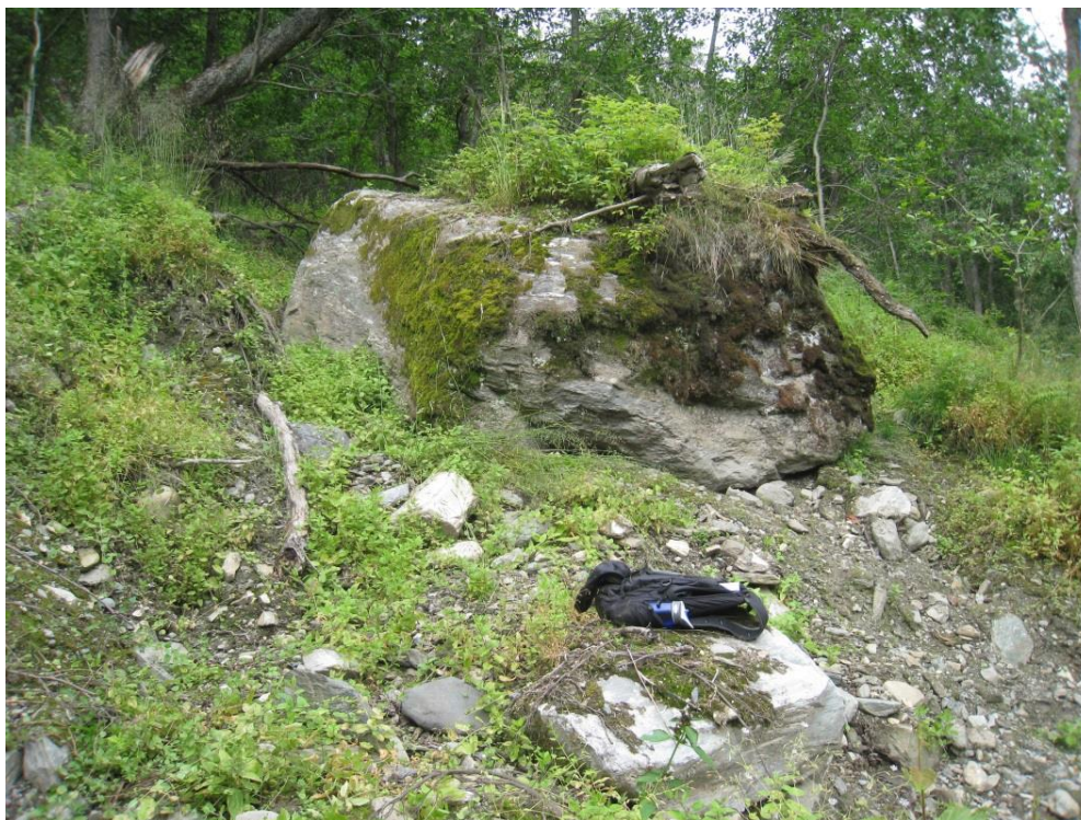
Figur 5.27 Bilde av utløsningsområde 4 i skred 3. Skredet har startet der hvor den store blokken befinner seg, og i bakkant av denne ble det observert et tørt bekkeløp med utløp i skredsåret. Det ble observert store variasjoner i kornstørrelse. Sekk representerer målestokk. Foto: Daniel Haugen Edvardsen.
