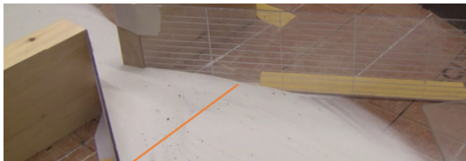
Figur 7.8: Lengde på tilbakeslagsbølge ved bruåpning på 8 cm og ledevollvinkel på 30^\circ (lengde 11 cm)
