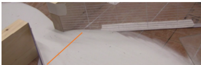
Figur 7.9: Lengde på tilbakeslagsbølge ved bruåpning på 12 cm og ledevollvinkel på 30^\circ (lengde 2 cm)
