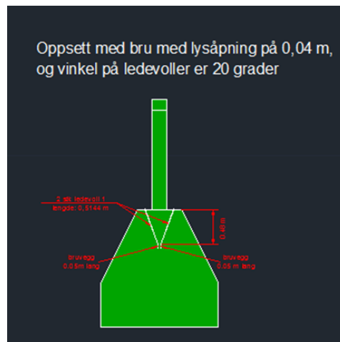
Figur A.4: Oppsett med bru med lysåpning 0,04 m og vinkel på ledevoller er 20 grader
