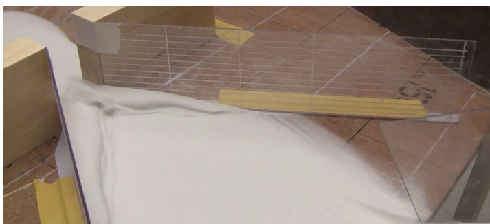
Figur 7.2: Oppskylling ved bruåpning på 8 cm og ledevollvinkel på 30^\circ (Oppskyllingshøyde 3,10 cm)
