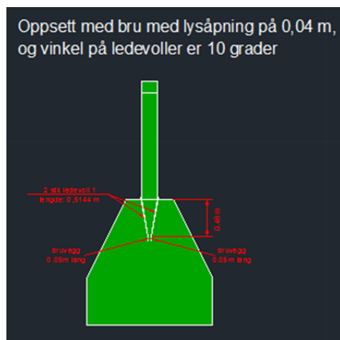
Figur A.5: Oppsett med bru med lysåpning 0,04 m og vinkel på ledevoller er 10 grader
