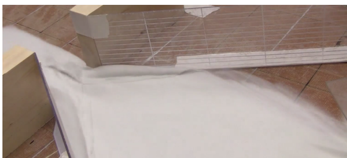
Figur 7.3: Oppskylling ved bruåpning på 12 cm og ledevollvinkel på 30^\circ (Oppskyllingshøyde 2,75 cm)
