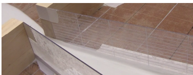
Figur 7.6: Oppskylling ved bruåpning på 8 cm og ledevollvinkel på 10° (Oppskyllingshøyde 2,10 cm)
