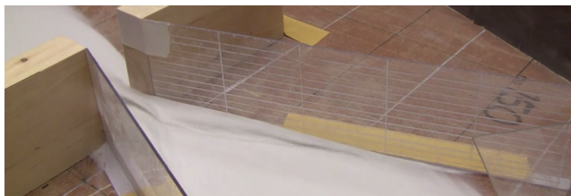
Figur 7.5: Oppskylling ved bruåpning på 8 cm og ledevollvinkel på 20° (Oppskyllingshøyde 2,90 cm)
