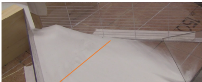
Figur 7.10: Lengde på tilbakeslagsbølge ved bruåpning på 4 cm og ledevollvinkel på 30^\circ (lengde 18 cm)
