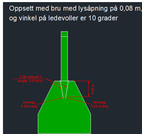
Figur A.8: Oppsett med bru med lysåpning 0,08 m og vinkel på ledevoller er 10 grader
