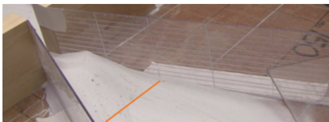
Figur 7.11: Lengde på tilbakeslagsbølge ved bruåpning på 4 cm og ledevollvinkel på 20^\circ (lengde 17 cm)
