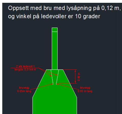
Figur A.11: Oppsett med bru med lysåpning 0,12 m og vinkel på ledevoller er 10 grader
