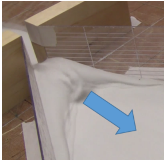
Figur 5.4: Tilbakeskyllingsbølgen oppstår etter at bølgefronten har truffet en hindring, og denne bølgen er motsatt rettet av skredretningen
