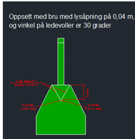
Figur A.3: Oppsett med bru med lysåpning 0,04 m og vinkel på ledevoller er 30 grader
