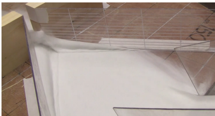
Figur 7.1: Oppskylling ved bruåpning på 4 cm og ledevollvinkel 30^\circ (Oppskyllingshøyde 6,20 cm)
