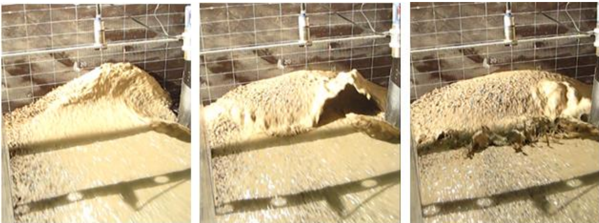
Figur 35: Bevegelse i møte med fangvoll for S2TV(90)H(90). T.v. oppskyllingshøyde, i midten bevegelse sideveis og tilbakeslag og t.h. bevegelse i massene grunnet tilbakeslag (foto: Christiansen).
