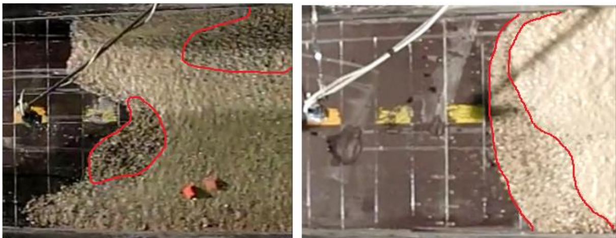
Figur 31: "Fryst" materiale markert med rødt, t.v. skred S2K(1,2) og t.h. skred S1TV(90)H(90) (foto: Christiansen).
