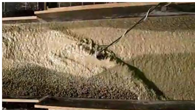
Figur 75: Strømning som skaper maksimal flyte høyde i skred S3K(1,2) (foto: Christiansen).
