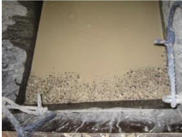
Figur 28: Massenes plassering i kassen før omrøring og initiering av skred (foto: Christiansen)
