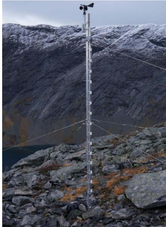
Figur 4.16 - SM4 (POLS Engineering) plassert like ved glidesonen på Stavbrekka oktober 2014. Temperaturtermistorer hver 20 cm logger temperaturen i snødekket hvert tiende minutt (foto: Martin Venås, 23. oktober 2014).
