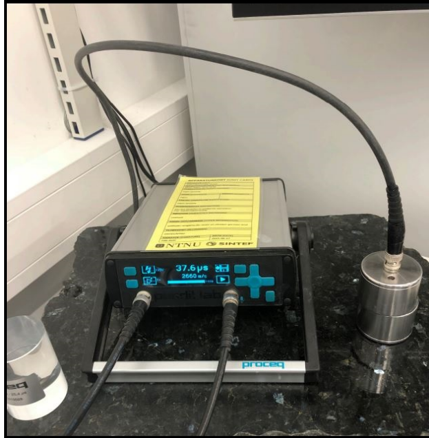
Figur 7.19: Apparat for måling av lyd hastighet (lydhastighetsmåler). Prøvene ble plassert mellom magnetene. Foto: Siri Engeskaug 30.01.20.
