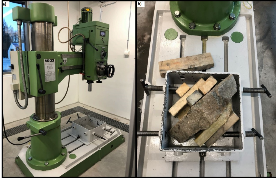
Figur 7.17: a) Radialbormaskin brukt for å bore bergkjerner og b) plassering av bergprøve i maskinen. Foto: Siri Engeskaug 28.01.20.
