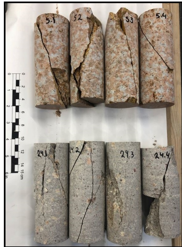
Figur 7.21: Kjerneprøver etter enaksiell trykktesting (Foto: Siri Engeskaug 31.01.20).
