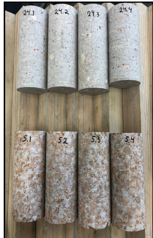
Figur 7.18: Kjerneprøver til enaksial trykktesting. Foto: Siri Engeskaug 30.01.20.
