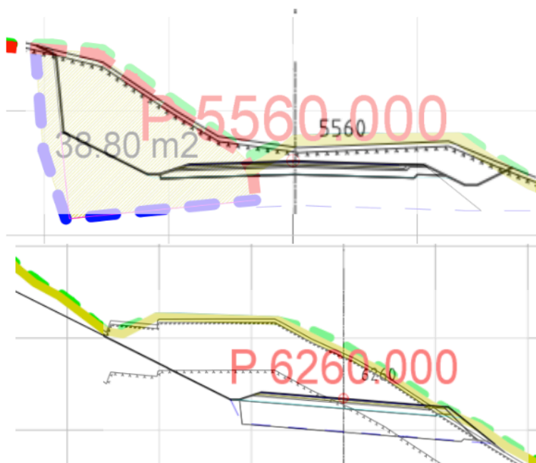
Figur 40: To profilar kor det prosjekterte fjellet (grå tagget strek) er feil slik at det blir meir lausmassar.
