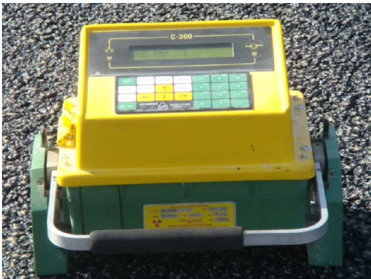
Bilde 46: Isotopmåler plassert på åpent asfaltdekke
