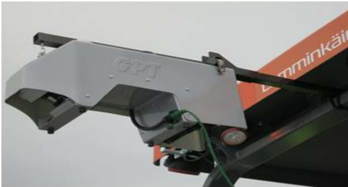
Bilde 41: IR-skanner montert bak på utleggeren
