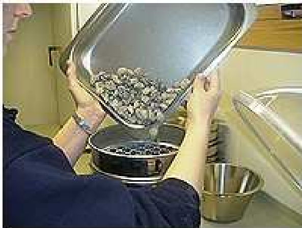
Bilde 20: Fra undersøkelse av flisighetsindeksen
