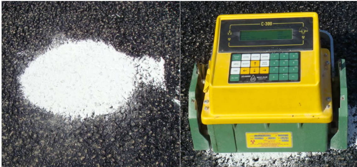
Bilde 47: a) Overflathull tettet med kalk
