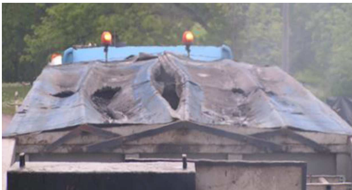
Bilde 22: Dårlig tildekking av baljen, kilde til varmetap
