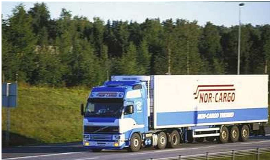
Bilde 2: Trippelboggi med supersingeldekk
