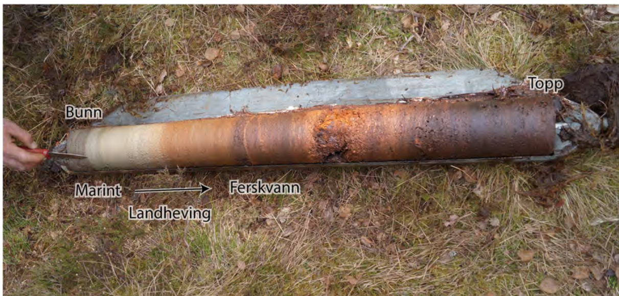
Figur 3–20 Kjerne tatt i en myr, topp er mot høyre med mørk brun organisk gytje, bunn av kjernen er mot venstre med grå glasimarine avsetninger og lite organisk materiale (Foto: Mari B. Nieuwenhuizen)
