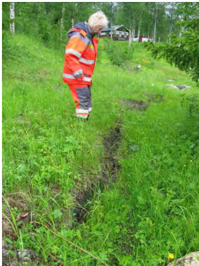
Figur 14–22 Bilde til venstre viser en sprekk i terrenget ovenfor en punktering med utvasking på Breivikeidet. Bilde til høyre viser utvasket vegbane etter endret artesiske trykk på Valebø, i Telemark (Foto: Elisabeth Gundersen og Bjørn K. Dolva, Statens vegvesen)
