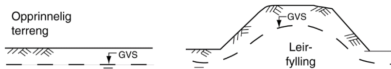
Figur 14–17 Oppfukting av leirfylling
