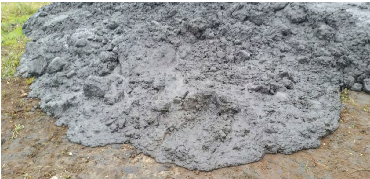
Figur 3–11 Bilde av oppbløtt Mjøsmorene som flyter ut (Foto: Siri Guldseth, SVV)
