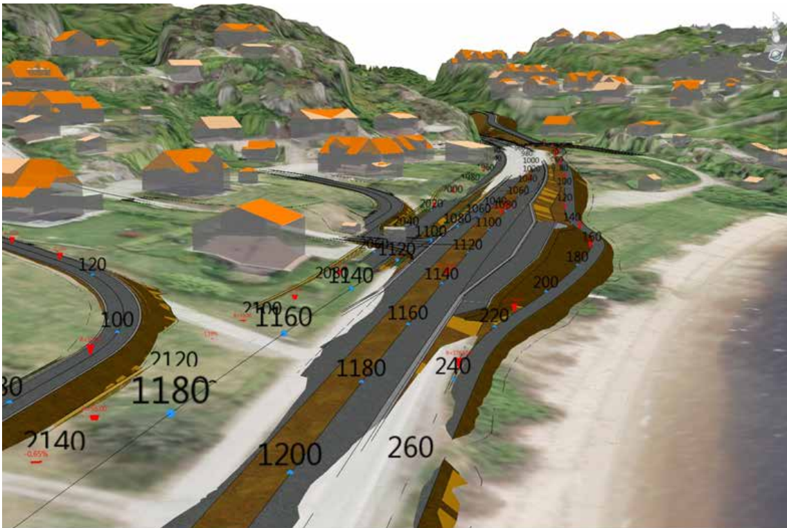
Figur 37 Tverrfaglig modell, tidlig i prosjekteringen. Kun vegmodell og eksisterende situasjon. Presentasjonen viser hvordan ny veg skjæres inn i/legges oppå eksisterende terreng
