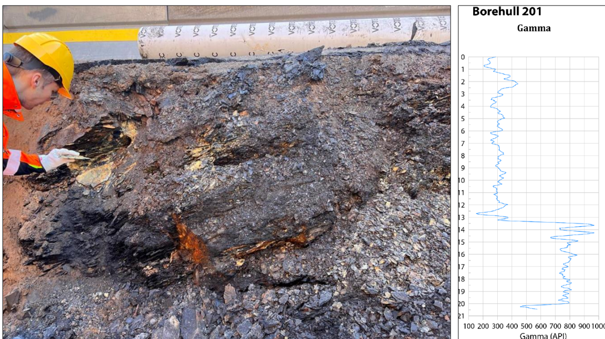
Figur 14. T.v: Alunskifer med omfattande forvitring ved Trefoldighetskirken ved Hammersborgtunnelen. Foto: Cecilie Hallingstad. T.h: Døme på borelogg frå Trefoldighetskirken ved Ring 1 som viser eit tydeleg sprang i gammastråling (teljingar per sekund etter API-standard). Øvste 13 meter er alunskifer/svartskifer med relativt låg stråling (ca. 300 cps) og høgare verdier lenger nede (Larsen og Gellein 2022).
