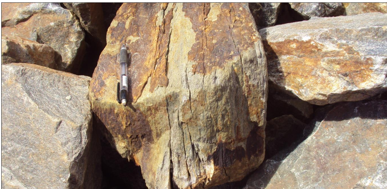
Figur 16. Gneis med varierende innslag av syregivande rustforvitring med gulleg jarositt. Total svovel i forvitringa variere mellom 5–15 %. Grå gneis utan forvitring inneheld magnetkis (pyrrhotitt) ofte i små mengder med totalt lite syrepotensial.
