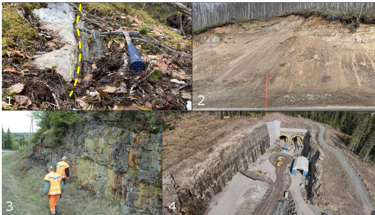
Figur 8: Nokre sider av miljøgeologisk problematikk. 1. Det er viktig å kartlegge grunnen for å nytte kortreist stein. Granitten t.v. har betre steinmaterialekvalitet enn metavulkanitten t.h. E6 Svenningelv–Lien. 2. Djupforvittra grovkorna granitt med dårleg bergmassekvalitet og stabilitet i bergskjering langs E6 i Ulvsvåg. Vegstikka er 2 meter høg. 3. Geologar undersøker blotning i bergskjering med alunskifer ved Rv 4 på Gran. 4. Dronefoto av søre påhogg i prosjektet E16 Bjørum – Skaret. Foto 1 og 2 Finn Sverre Karlsen, 3. Per Hagelia, 4. Terje R Kirkeby.
