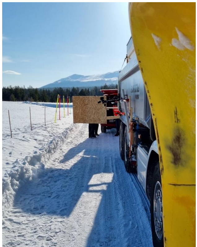
Figur 46: Vinge benyttet til å simulere slag fra plog.
