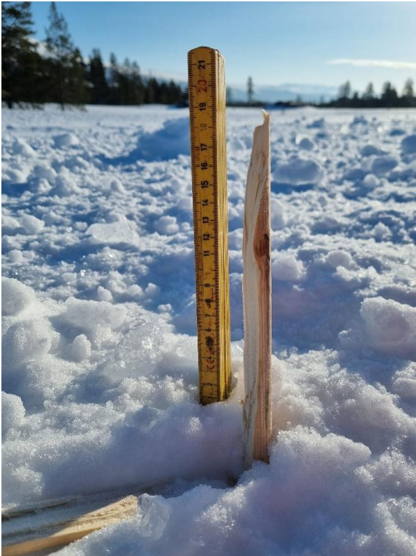
Figur 47: Furu limtre som har gått til brudd.
