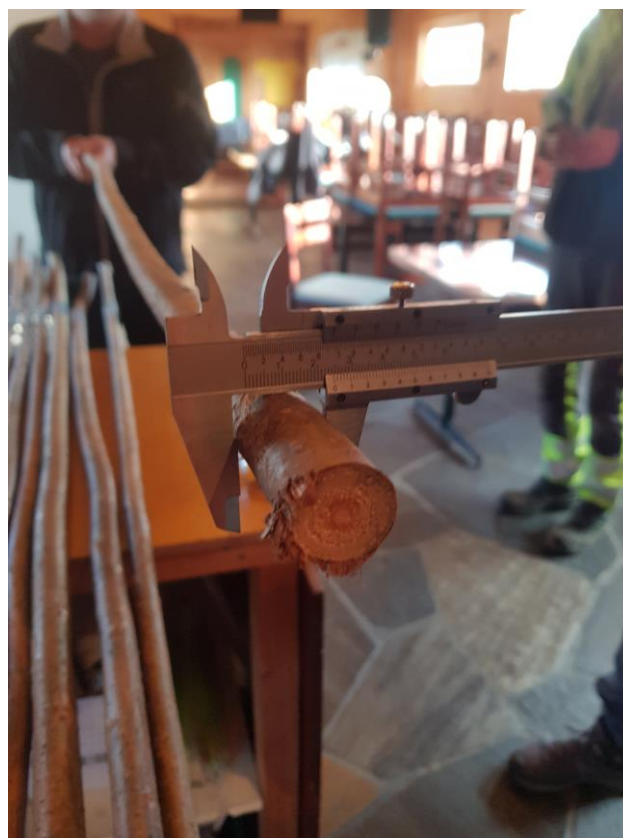
Figur 41: Tykkelsesmåling (rotende) samtidig med veing.
