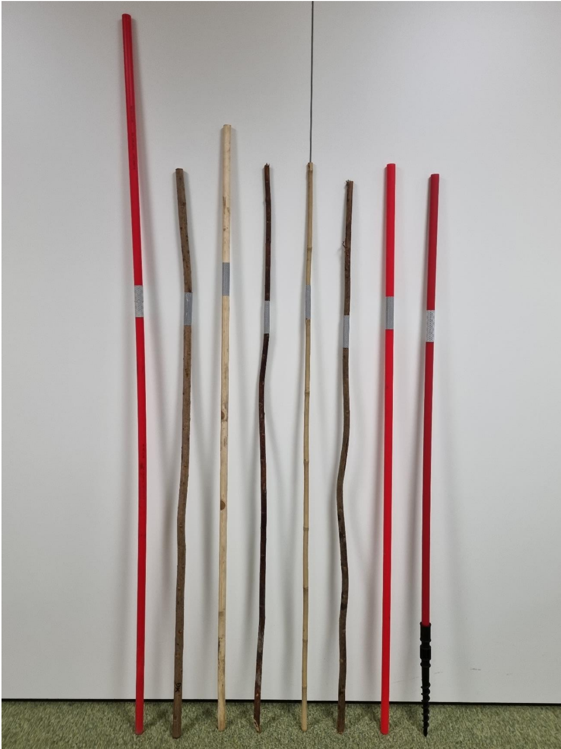
Figur 1: Testede stikketyper vinteren 2021/2022. Plast rød (f.v.), Pil Dansk, Furu limtre umalt, Pil Svensk 18 mm, Bambus 18/20 mm, Pil Svensk 22 mm, Plast RØD og Skrustikk rød.
