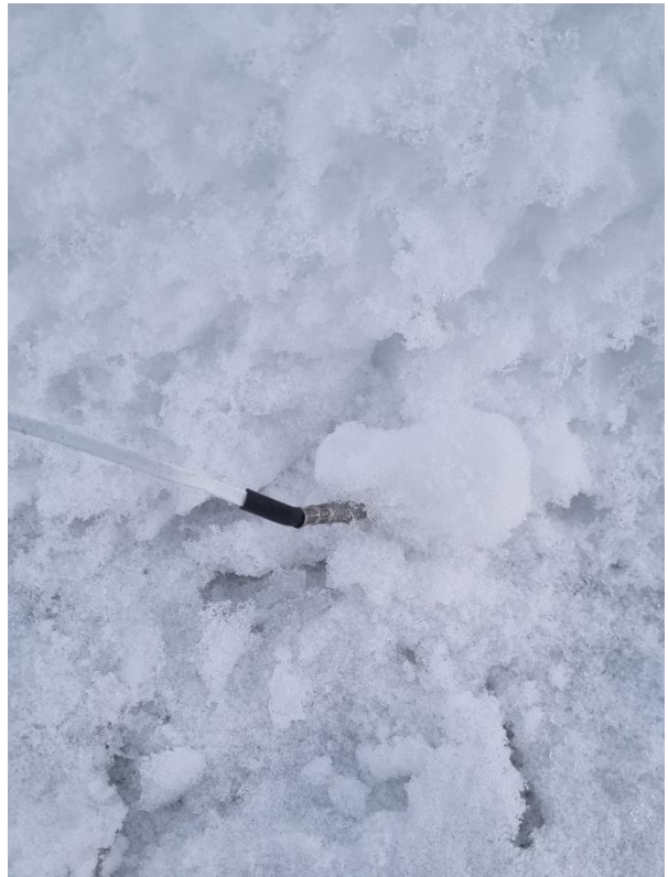
Figur 27: Måling av veibanetemperatur med probe.
