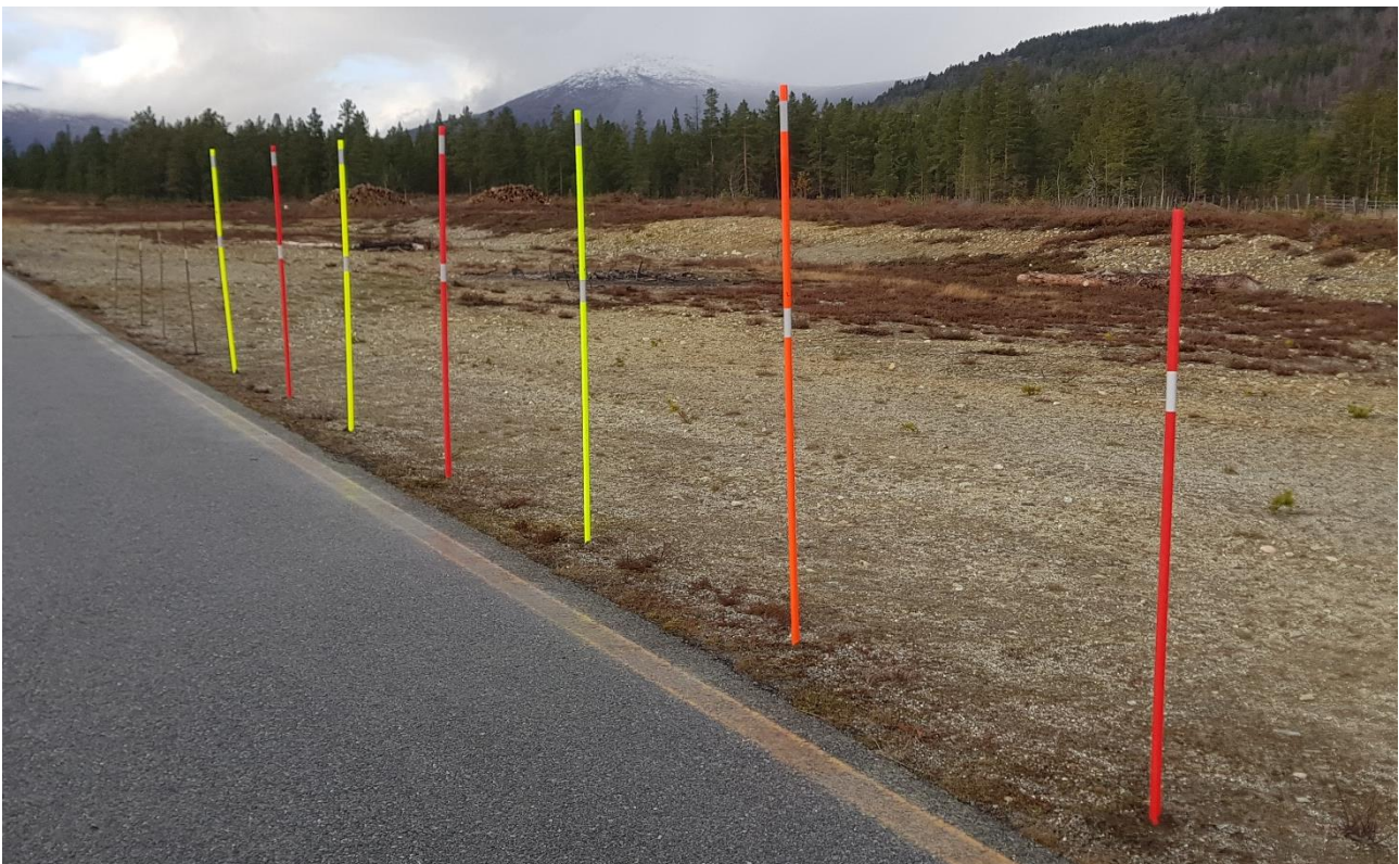
Figur 13: Fluoriserende stikk vs. ordinære på Bjorli i oktober 2021. Forfra (f.h.): Plast RØD, Fluoriserende rød (PC), Fluoriserende gul (PC), Plast rød (Ø33 mm), Fluoriserende gul (PP), Plast rød (Ø33 mm), Fluoriserende gul (PP) og Pil Svensk 22 mm (4 stk).
