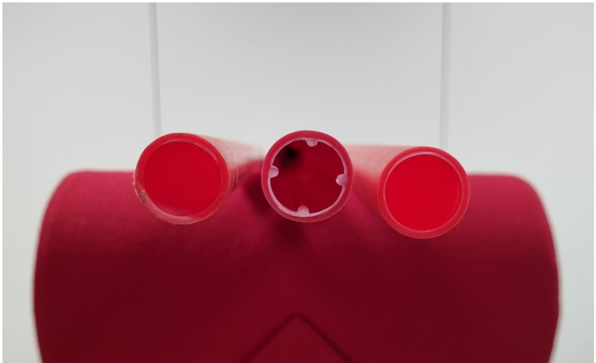
Figur 12: Innvendige riller («forsterkning») vs. ikke. Plast rød (f.v.), Skrustikk rød og Plast RØD.
