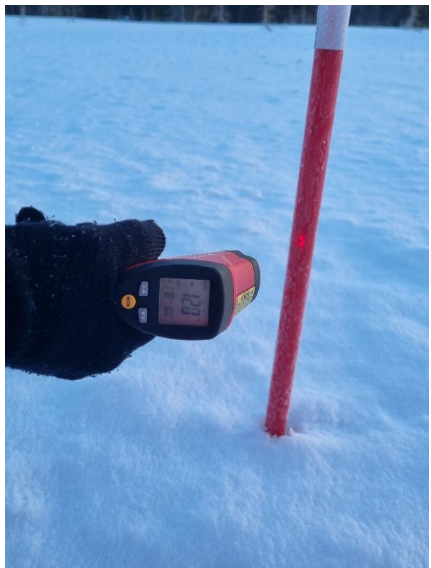
Figur 29: Måling av stikketemperatur.
