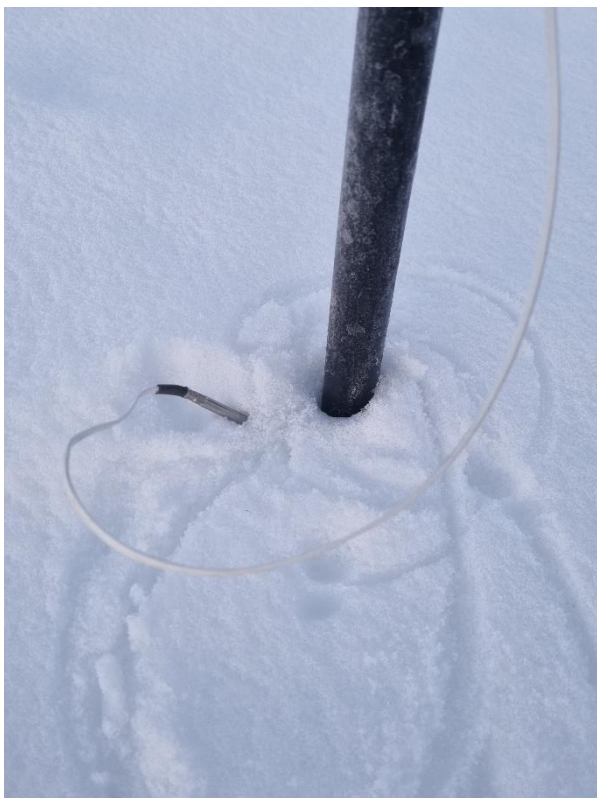
Figur 28: Måling av snøtemperatur (nært brøyttestikken).
