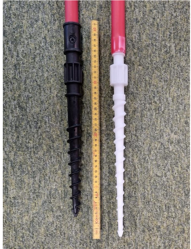
Figur 11: Ny (videreutviklet) type plastskruer (sort) vs. fjorårets type (hvit).
