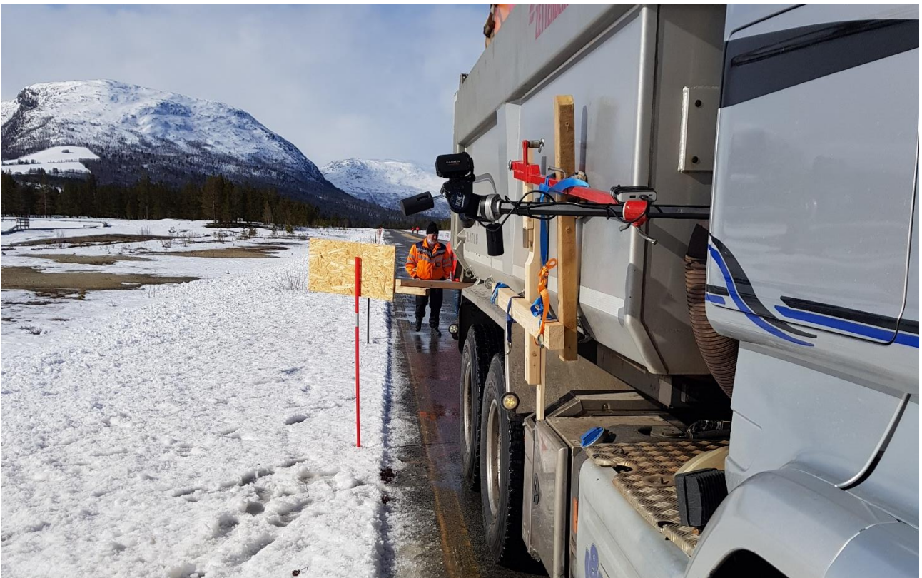
Figur 64: Vinge benyttet til å simulere slag fra plog. Her i høyeste posisjon – 120 cm over bakken (25-30 cm ned på stikken).
