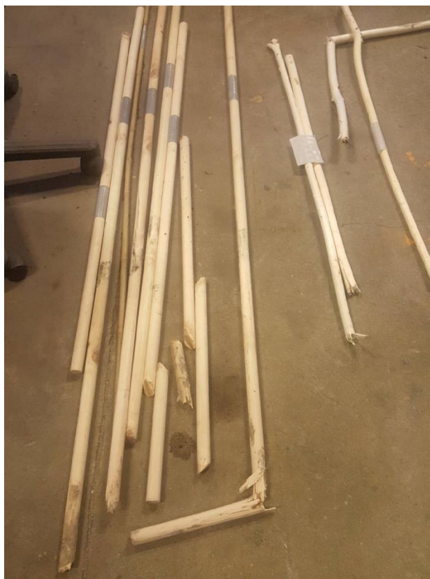
Figur 42: Skader ifbm utsetting (Foto: Harald Åge Helle)
