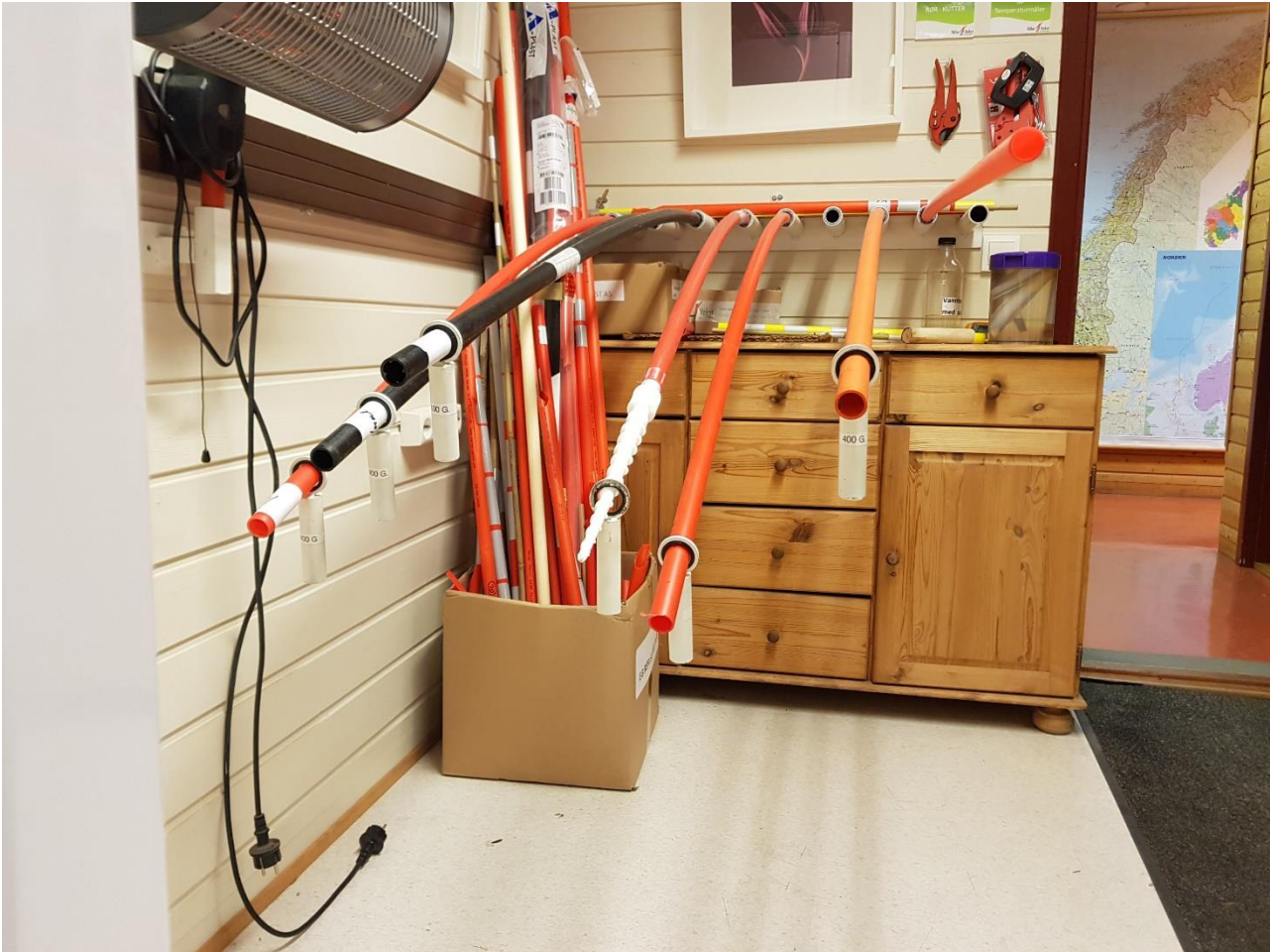
Figur 75: Bøyetest igangsatt. Plast RØD (f.v.), Plast SVART, Plast Resirk SVART, Skrustikk RØD og Demo RØD.
