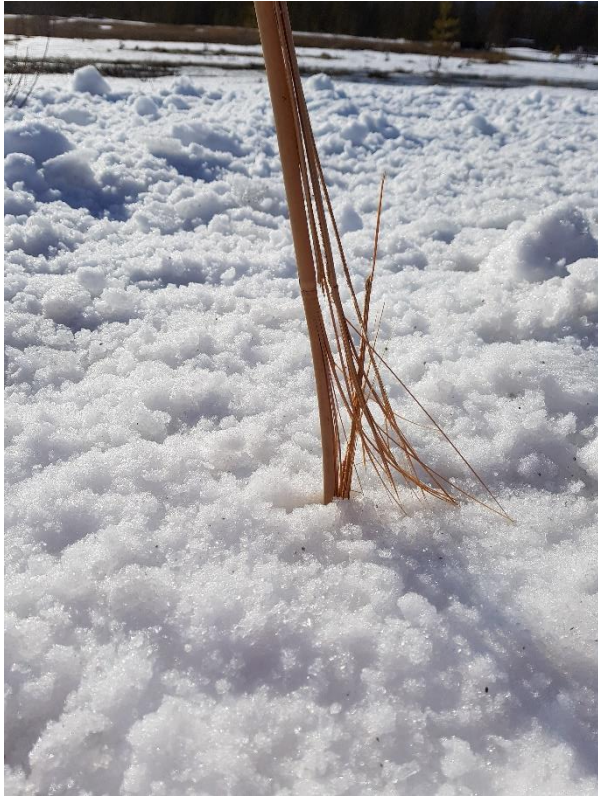
Figur 69: Splintret bambus (t.v.) fra belastningstest 1 og bambus nedbrøytet av fres (t.h.) ifbm belastningstest 2.
