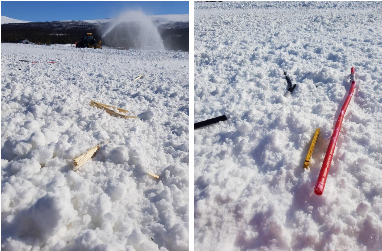
Figur 72: Eksempel på stikk som har gått gjennom snøfresen. Oppstykket pil til venstre, helt og todelt plaststikk til høyre.
