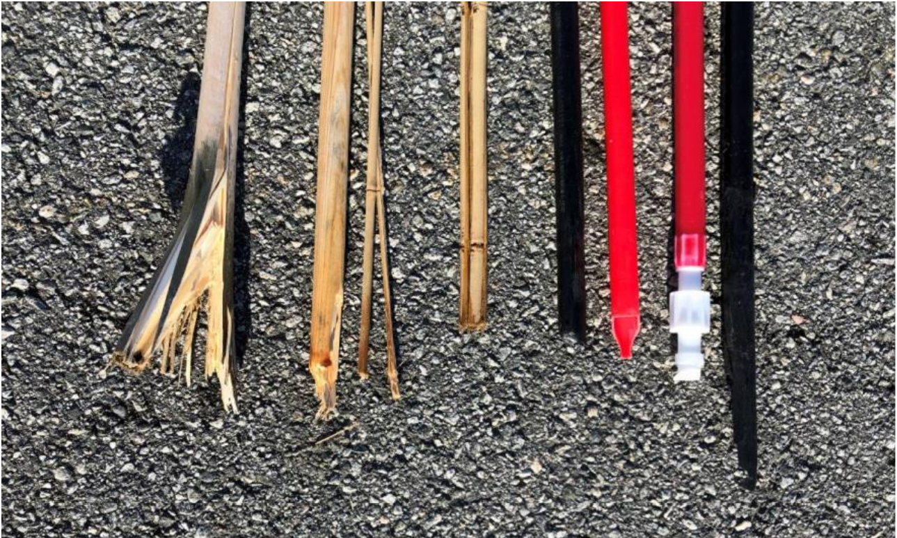
Figur 67: Typiske skader og bruddflater. Fra venstre: Pil, furu, bambus tynn og tykk, plast svart og rød, skrustikk og resirkulert plast.
