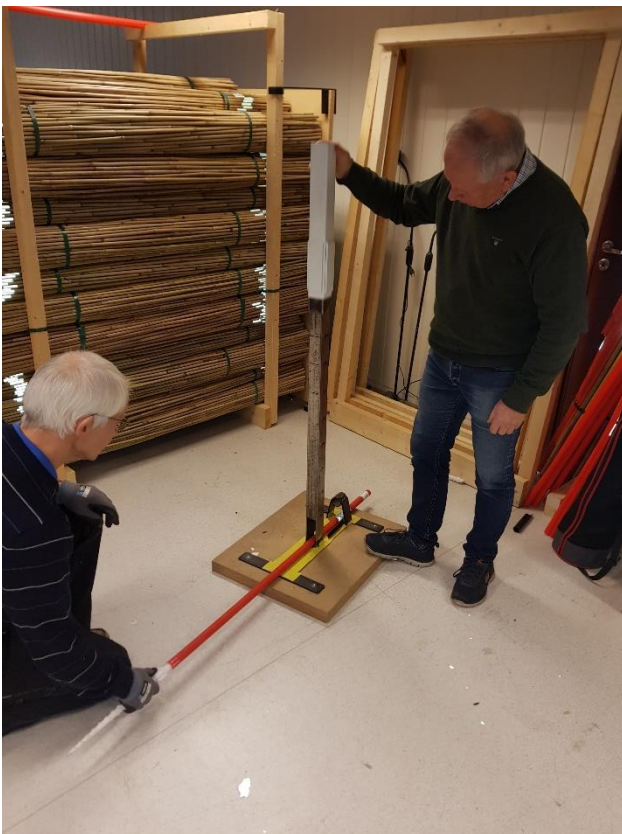
Figur 73: Slagtest (kuldeegenskaper) vha. giljotin
