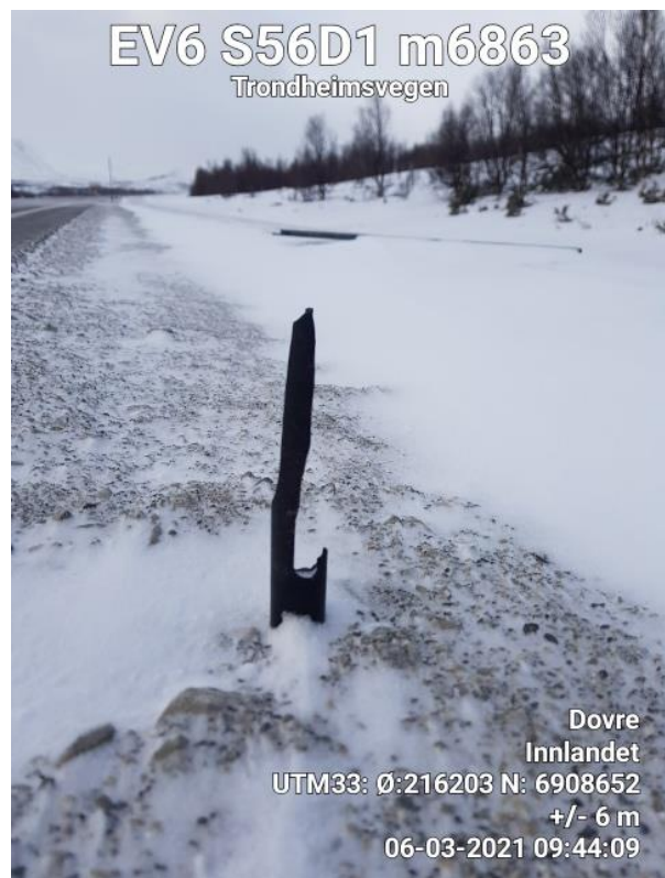
Figur 57: Rest i vegskulder av knekt pil (t.v.) og resirkulert plast (t.h.) E6 Dovrefjell
