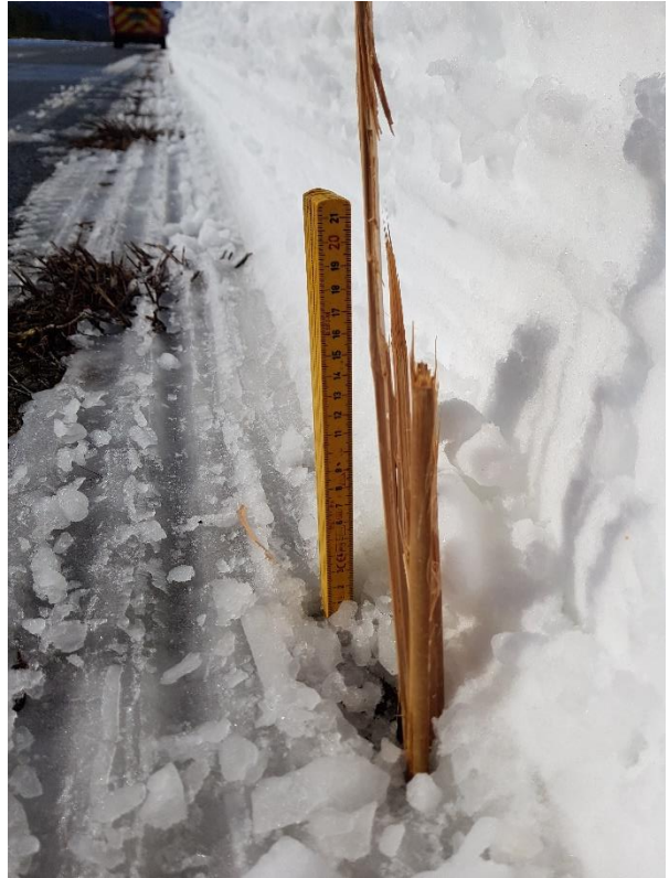
Figur 69: Splintret bambus (t.v.) fra belastningstest 1 og bambus nedbrøytet av fres (t.h.) ifbm belastningstest 2.
