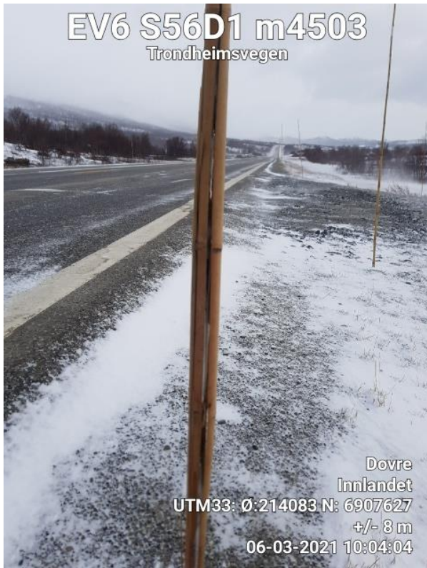
Figur 56: Spjæret bambus og furu som har knekt i kvist E6 Dovrefjell
