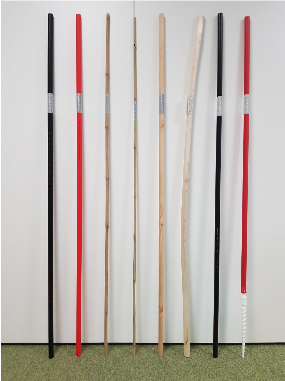
Figur 1: Testede stikketyper vinteren 2020/2021. Plast SVART (f.v.), Plast RØD, Bambus TYKK, Bambus TYNN, Furu, Pil, Plast Resirk SVART og Skrustikk RØD.
