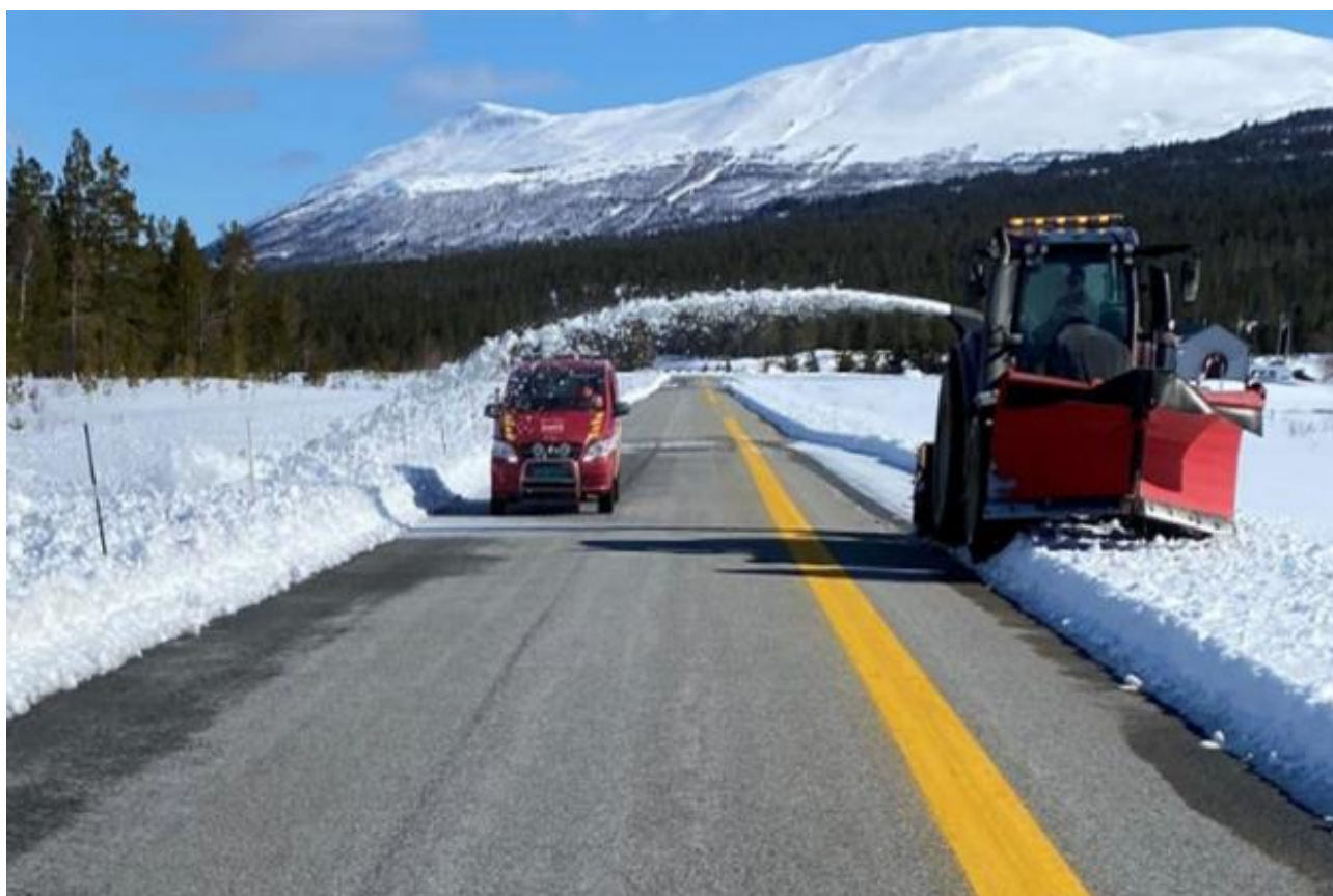
Figur 66: Traktor med fres i aksjon (sprut fra fres) i forbindelse med belastningstest 2.
