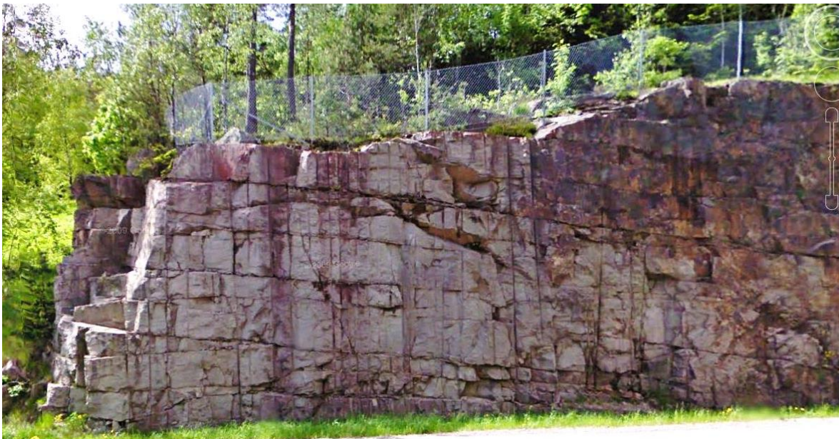
Figur 4.14 Avlastningssprekker, som nær horisontal benkning i syenitt, langs rv. 4 Gjelleråsen i Oslo. Foto: Google Earth.
