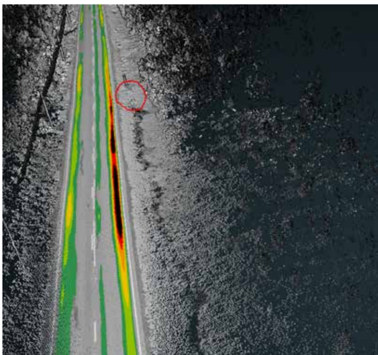
Figur B3.1 Tett stikkrenne i en avkjørsel fører til økt spordannelse oppstrøms (rød og svart farge er dypest spor) [35].
