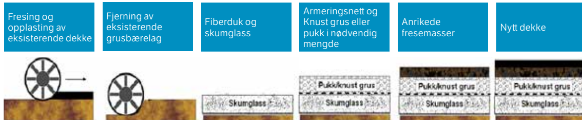
Figur B19.4 Eksempel på fremgangsmåte ved forsterkning på myr eller torv. (Ill: Per Otto Aursand, Statens vegvesen).
