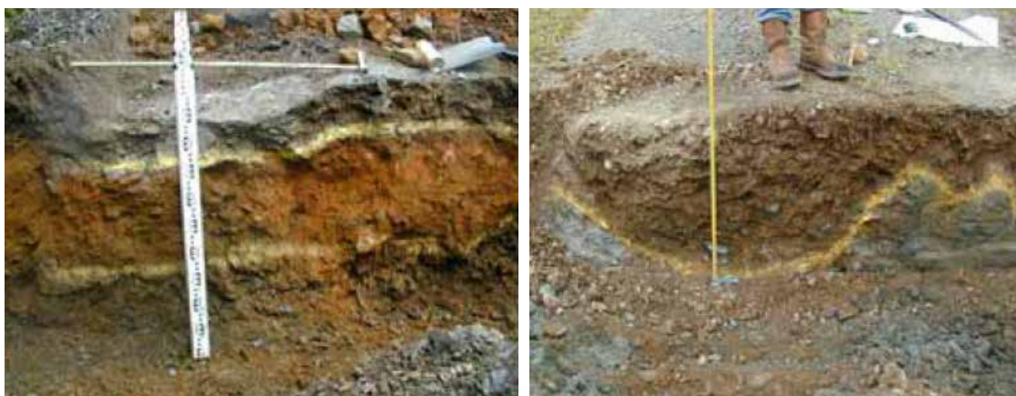
Figur A4.3 Ved oppgraving kan man kartlegge sportype ved å se på hvor deformasjonen finner sted. Til venstre sportype 1 og til høyre sportype 2. [33]
