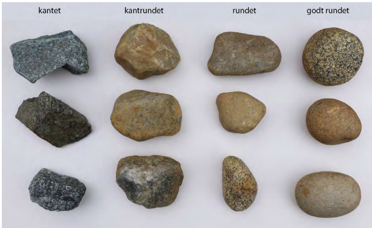
Figur 3-5 Inndeling av steiner etter fire rundhetsklasser Foto: Terje H. Bargel, NTNU
