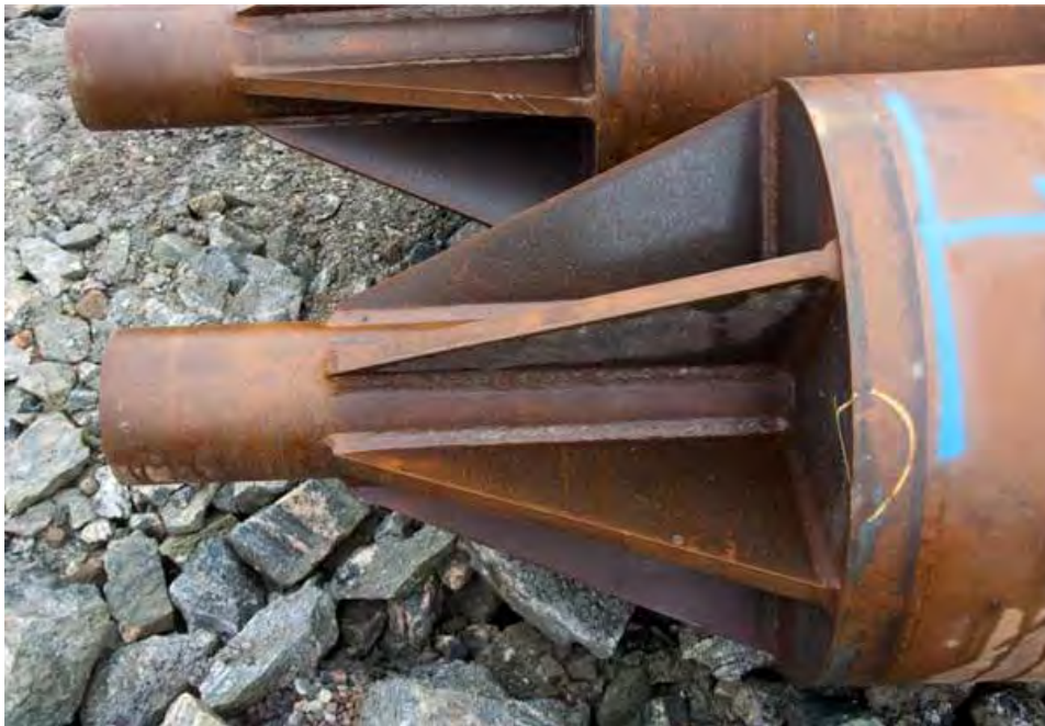
Figur 11-4 Bilde av pelespiss som viser dubb, avstivingsribber og endeplate (Statens vegvesen VD rapport nr. 34 [19])
