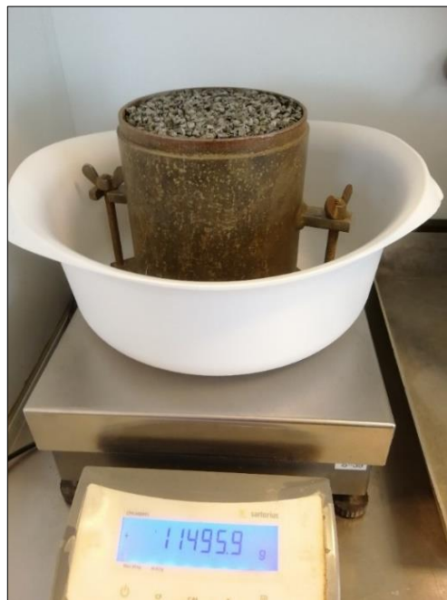
Figur 6. Fylt CBR-form i vannfylt plastbalje. Figur 7. Veiing av plastbalje og fylt CBR-form.
