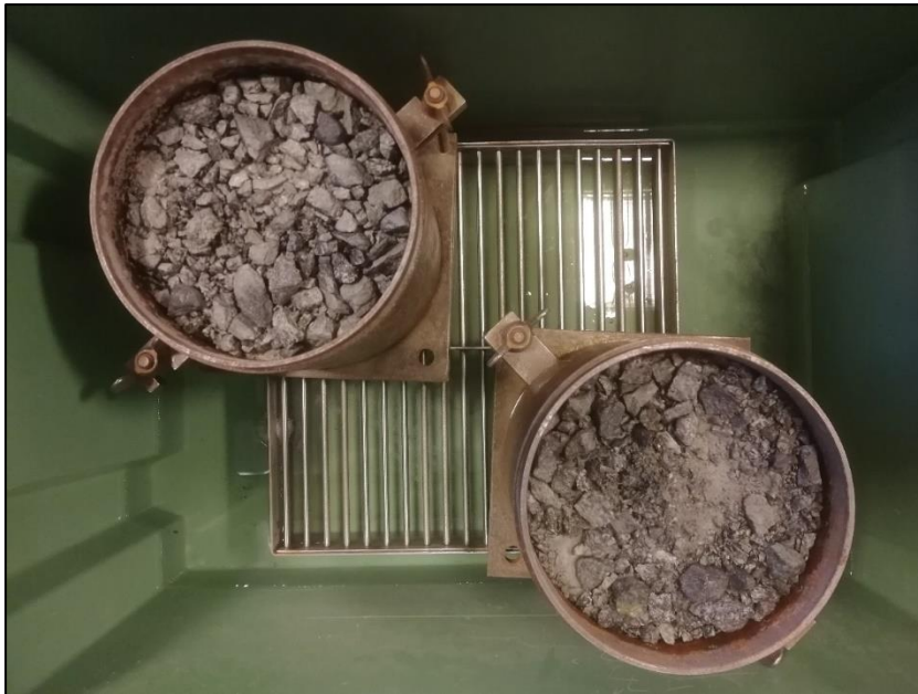
Figur 10. Vanntilsatt materiale 0-16 mm med (til høyre) og uten (til venstre) finstoff.
