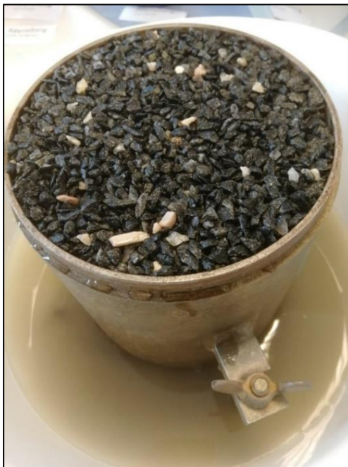
Figur 6. Fylt CBR-form i vannfylt plastbalje. Figur 7. Veiing av plastbalje og fylt CBR-form.
