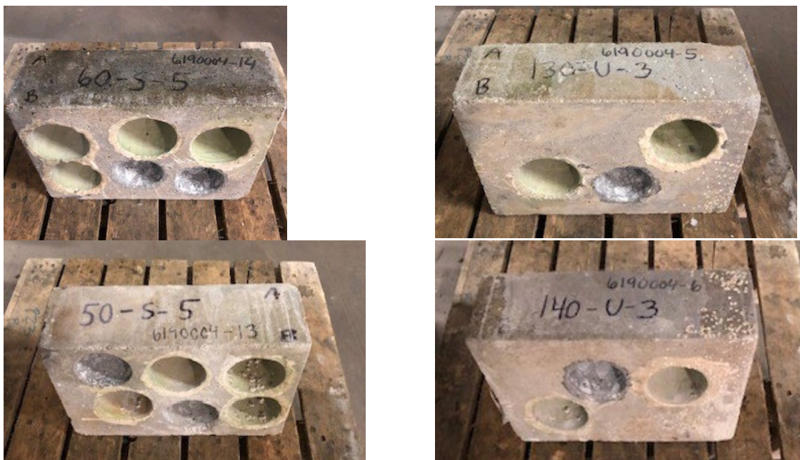
Figur 10 Foto av elementer etter utboring av kjerner, silanimpregnerte elementer til venstre, ubehandlede til høyre. Foto: Sentrallaboratoriet, Statens vegvesen.
