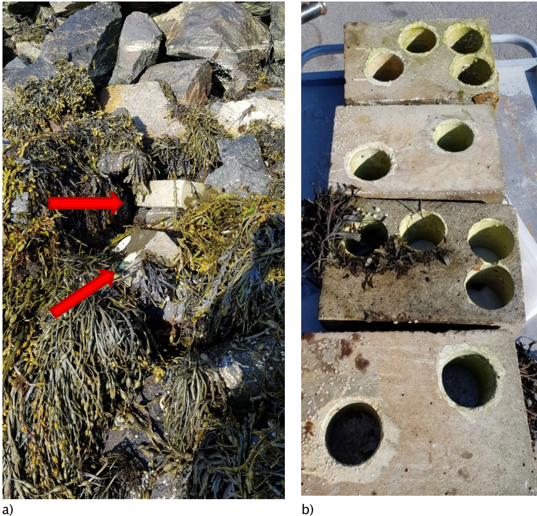
Figur 9 a) Etter utplassering i 2015 ble små elementer plassert i fylling i tidevannssonen ved kaia (røde piler). b) Små elementer etter opphenting etter 5 års eksponering. Foto: Martin Gedra, Statens vegvesen.
