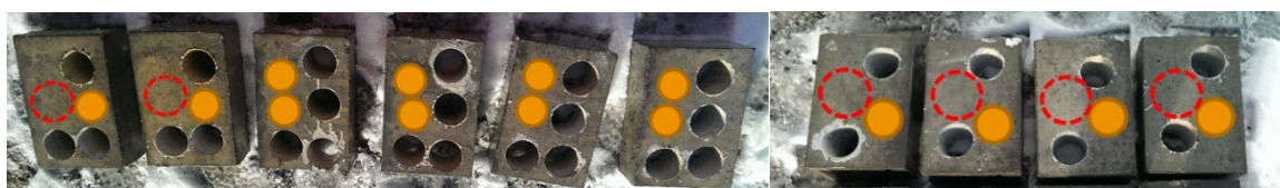
Figur 3 Prinsippskisse for utboring (S-elementer til venstre, U-elementer til høyre). Kjerner merket med gult ble boret ut i Molde. Kjerner merket med stiplet rødt ble boret ut i Oslo.
