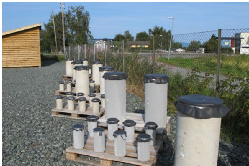
FIGUR 22 SMÅ OG STORE SYLINDRE, MED OG UTEN OVERFLATEBEHANDLING UTPLASSERT PÅ SINTEFS FELTSTASJON. FOTO: EVA RODUM, STATENS VEGVESEN.
