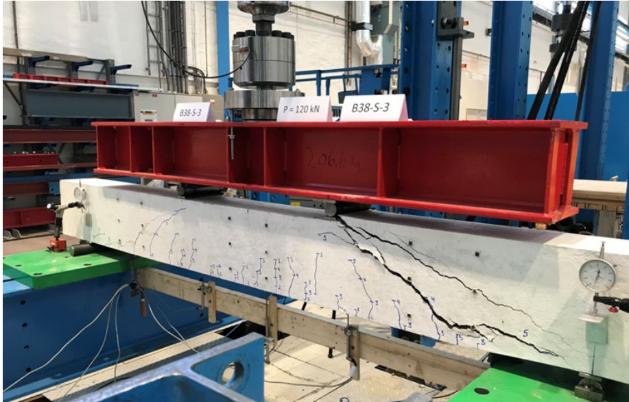
FIGUR 21 BJELKE MED AR-EKSPANSJON BELASTET TIL SKJÆRBRUDD I LABORATORIET. FOTO: KATHRINE MÜRER STEMLAND, NTNU.
