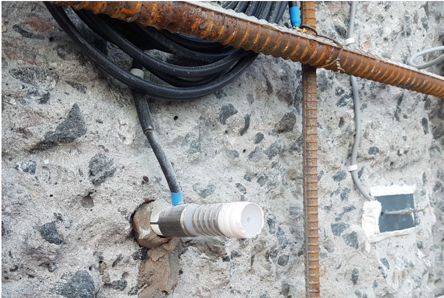
FIGUR 15 - MULTIRINGELEKTRODE (MRE) FØR INNSPRØYTING BRUKT UNDER FELTFORSØK VED TJELDSUNDBRUA. FOTO: KARLA HORNBOSTEL, STATENS VEGVESEN.
