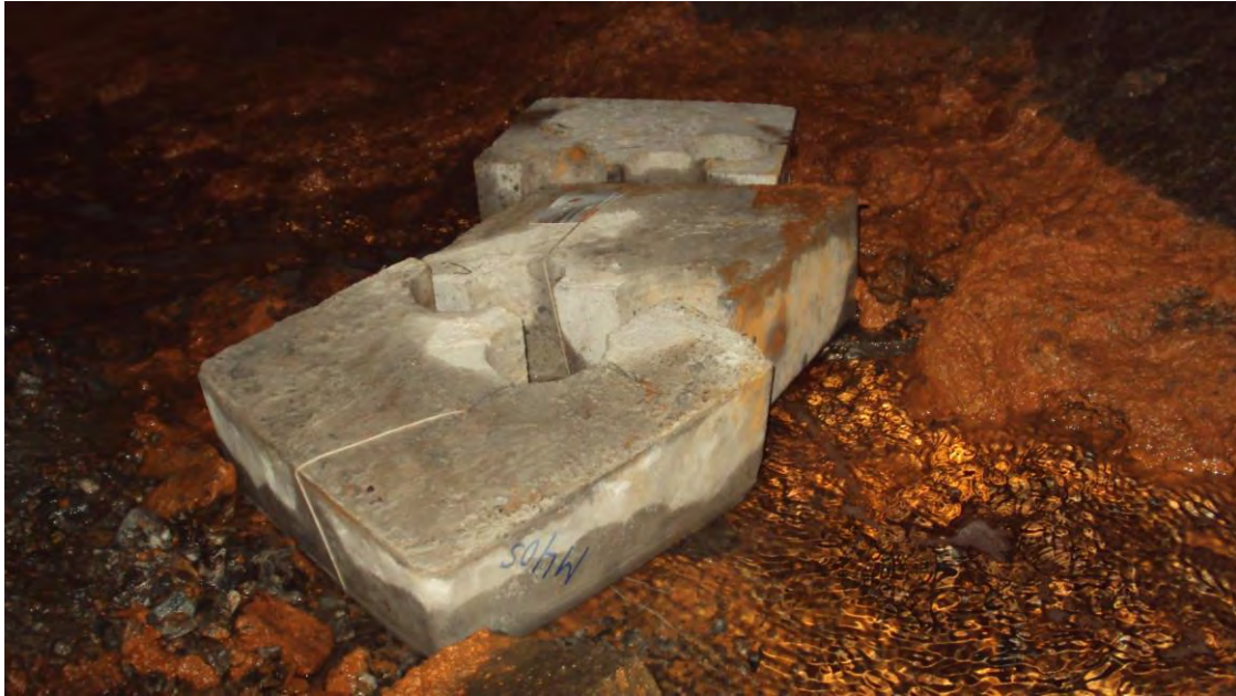
V6.9. Grøft A, 1 juni 2010. Karprøver av reseptane 1, 2 og 3 blei plasserte eit stykke oppstrøms plateprøvene (foto same dag). Vasstanden auka etter kvart. Før utplassering var det bora ut to sett sylindrar av kvar resept for testing av utgangseigenskapar ved Sentrallaboratoriet. Planlagt utboring av sylindrar for testing etter 5 og 10 års eksponering. Foto: Per Hagelia.
