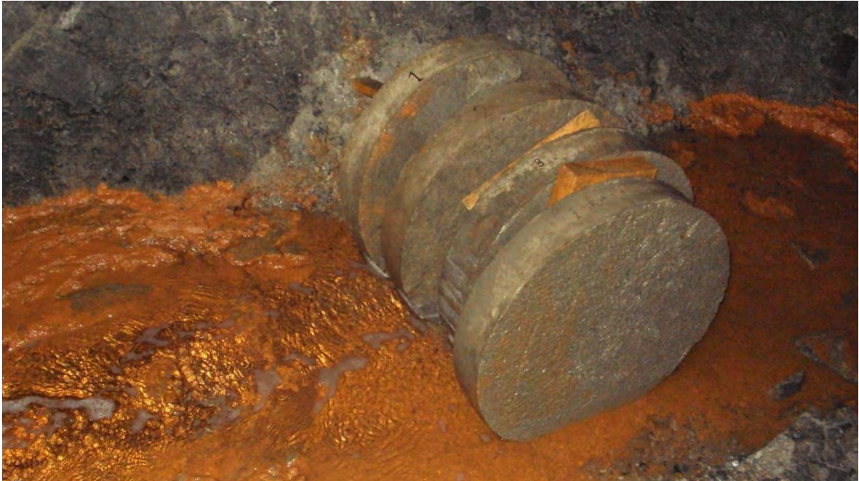
V12.13. Grøft A mai 2010 rett etter utplassering av plateprøver for testing av energiabsorpsjon. Foto: Per Hagelia.
