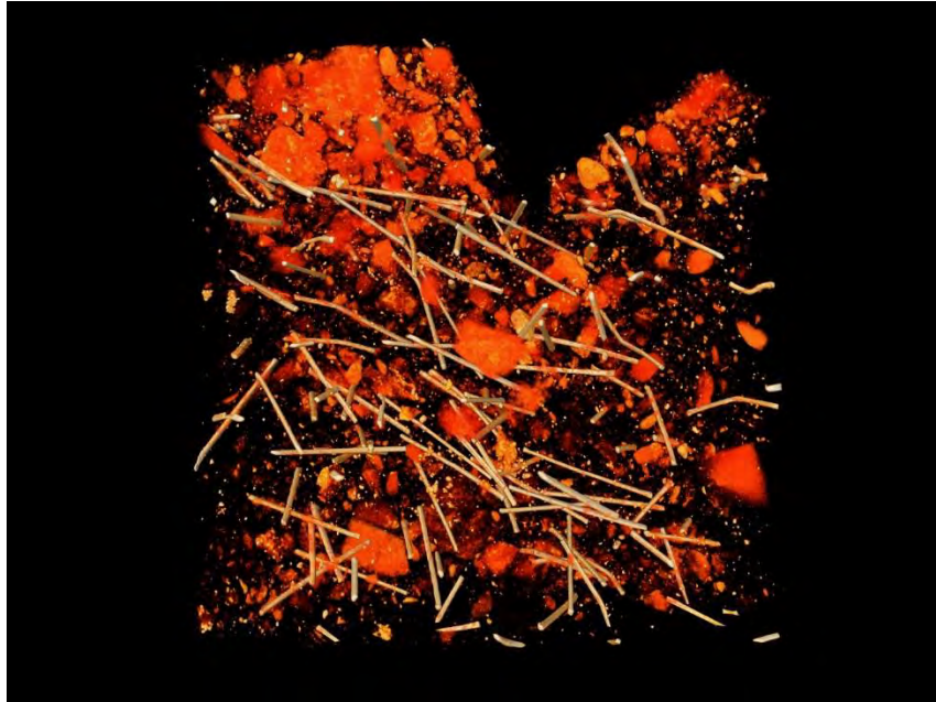
V14.2. Kjerne FB-1 etter CT-scanning og bildebehandling med terskel sett slik at både stålfiber og tilslag kjem fram. Sett frå same retning som i V14.1 venstre bilde. Her ser vi inn i prøva, tre dimensjonar er representerte og det er muleg å rotere. Foto: Øyvind Hammer.
