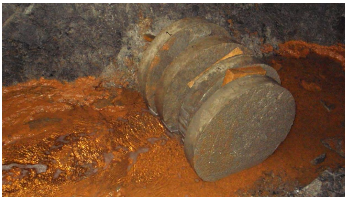
V6.6. Grøft A. Prøver for testing av energiabsorpsjon bli utplasserte den 5 mai 2010 (foto same dag). Prøve nr 1, 2 og 3 er støypte plater (hhv. resept 1, 2 & 3) og sprøyta plateprøve (nærmast) med resept 3 (M40). Testing planlagt i 2020. Vasstanden i grøfta var låg til å begynne med, men har auka mykje i åra etter, hovudsakleg på grunn av opphoping av jernbakteriar. Vatnet renner mot høgre i biletet. Foto: Per Hagelia.
