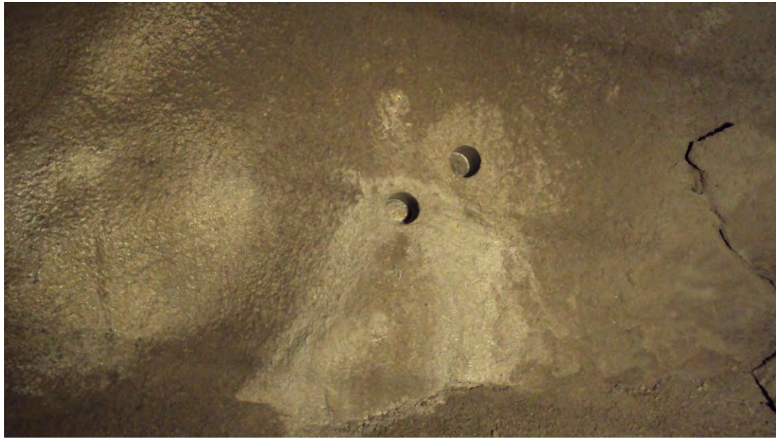
V6.3. Felt 3. Borepunkt for sprøytebetongsylindrar, prøve 3.1 (høgre) og 3.2 (venstre). Betongalder 40 dagar. Foto: Per Hagelia.
