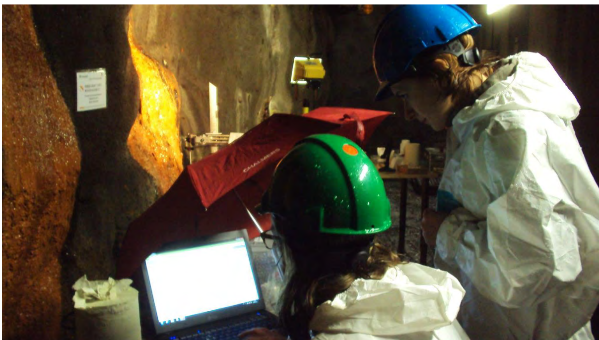
V12.16. Frå lokalitet ved pumpesumpen i Oslofjordtunnelen. Måling av pH og oksygenmetting gjennom biofilm i samband med doktorgradsarbeidet til Sabina Karačić (blå hjelm). Brit-Marie Wilén (grøn hjelm ved datamaskina). Arbeidet med sensitivt utstyr under drypplekkasjar er krevande. Foto: Per Hagelia.
