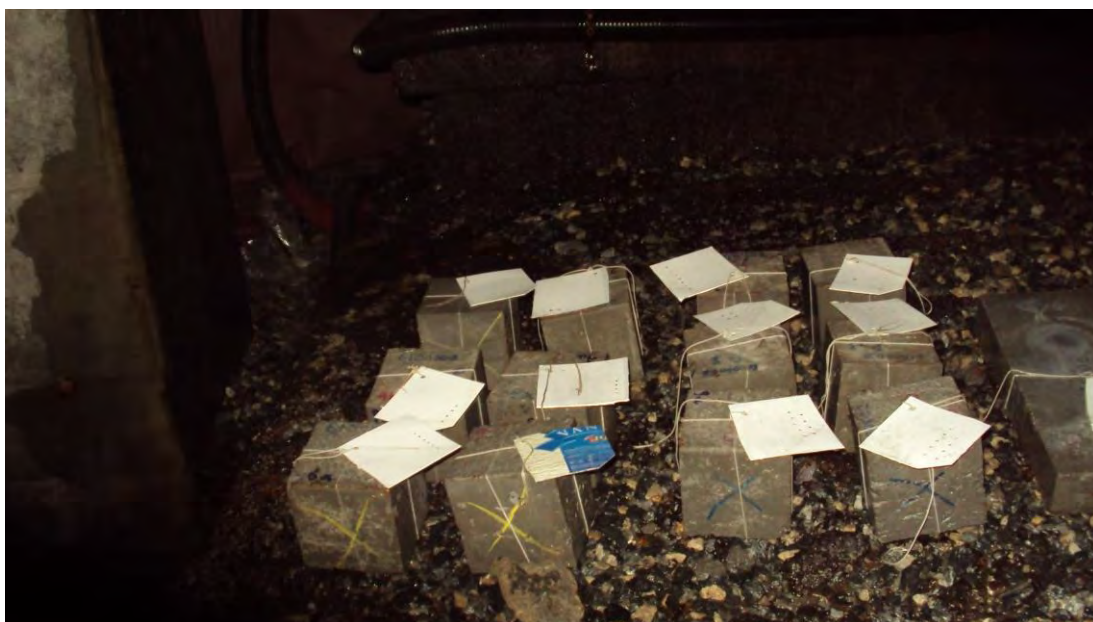
V6.14. Bankett rett innanfor døra ut mot trafikkrommet. Det blei støypt totalt 18 terningar; 3 sett prøver av kvar resept). To terningar av kvar resept blei undersøkt i laboratoriet for å bestemme utgangsegenskapane. Resten, totalt 12 terningar, blei plassert ut 5 mai 2010 med tanke på lufteksponering og testing etter 5 og 10 år. I samband med anna arbeid i tunnelen omkring 2013 hadde nokon forsynt seg med eit par av terningane, og vi valte derfor å avslutte forsøket etter 5 år. Foto: Per Hagelia.
