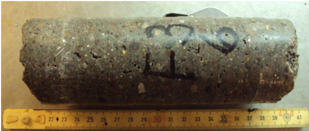
Figur 62: Felt 3-2015. Kjerne F3-6. Utan spesielle teikn på primær fiberkorrosjon mot overflata (venstre) og elles med tydeleg intakt stålfiber (blanke).
