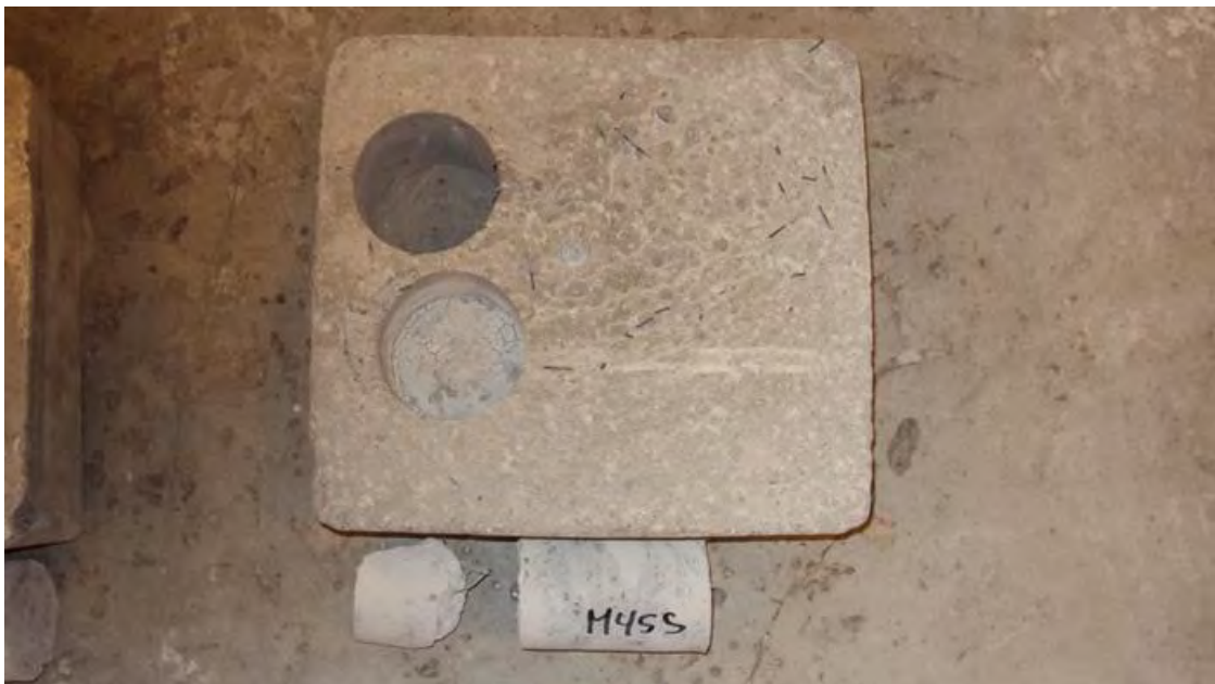
V6.10. Sylindrar ( \Phi = 75 mm) bora ut frå karprøver for analyse av utgangseigenskapar. Resept 1 (M45S+P) tilsvarande sprøytebetongen i Felt 1. Foto: Per Hagelia.
