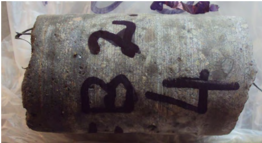
Figur 59: Felt 2-2015. Kjerne FB2-4 med PP-fiber.
