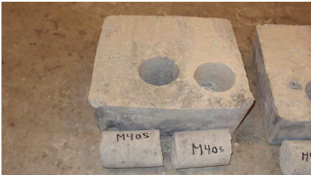
V6.12. Sylindrar ( \Phi = 75 \text{ mm} ) bora ut frå karprøver for analyse av utgangsegenskapar. Resept 3 (M45S+P) tilsvarande sprøytebetong i Felt 3. Foto: Per Hagelia.
