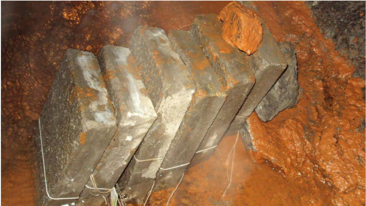
V12.9. Grøft A mai 2010 rett etter utplassering av plateprøver. Merk låg vasstand i første tida. Foto: Per Hagelia.
