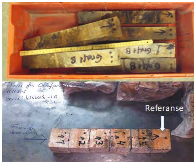
Figur 76: Øvst: Alle plateprøvene blei kapp opp på langs i tre parallelle delprøver. Den sentrale delen blei brukt for kloridinntrenging og ein annan del blei brukt for kapillærsug og porøsitet. Nedst: Delprøvene for samanlikning av kloridinnhald og porøsitet blei kapp opp i fem 50 mm terningar frå botnen av grøftene og 250 mm oppover, samt 50 mm terningar som referanse frå den ueksponerte toppen av kvar plateprøve. Dei siste delprøvene blei reservert for tynnslip av den nedste delen mot botnen av kvar grøft. Foto: Trond A. Lorentzen.
