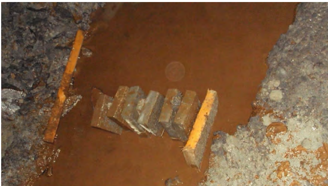
V6.13. Grøft B den 5 mai 2010 rett etter plassering av A4-plater. To sett av kvar resept (1, 2 & 3) for testing etter 5 og 10 års eksponering. Det opphavlege mørke manganrike vatnet var blitt rustfarga på grunn av rennande vatn i samband med meisling av gammal betong og sprøyting av Felt 1, 2 og 3 oppstrøms. Etter kvart som tida gjekk blei vatnet i Grøft B mørkare igjen (innan 2011). Foto: Per Hagelia.
