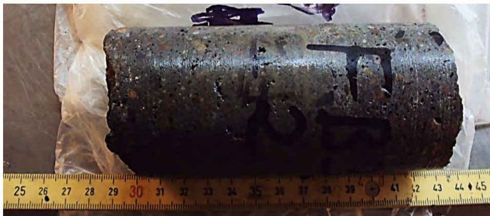
Figur 57: Felt 2-2015. Kjerne FB2-2 med PP-fiber. Overflate mot venstre utan fiberkorrosjon.
