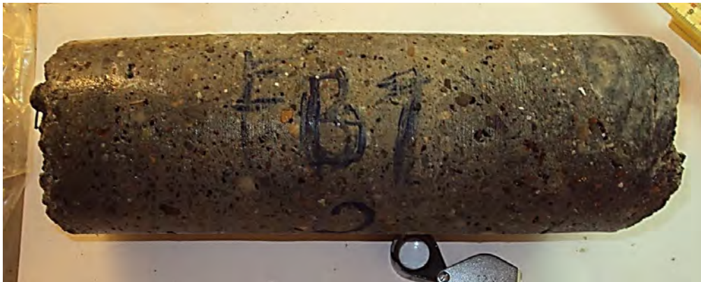
Figur 56: Felt 1-2015. Kjerne FB1-2 nesten utan fiberkorrosjon, med unntak av marginal korrosjon ytterst mot biofilm.
