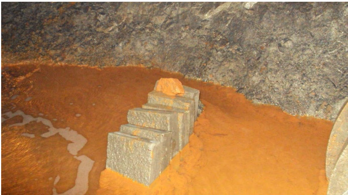
V6.8. Grøft A, 1 juni 2010. To sett A4-plater av kvar resept (1, 2 & 3) for testing etter 5 og 10 års eksponering. Platene var plasserte i grøfta 5 mai 2010. Foto: Per Hagelia.
