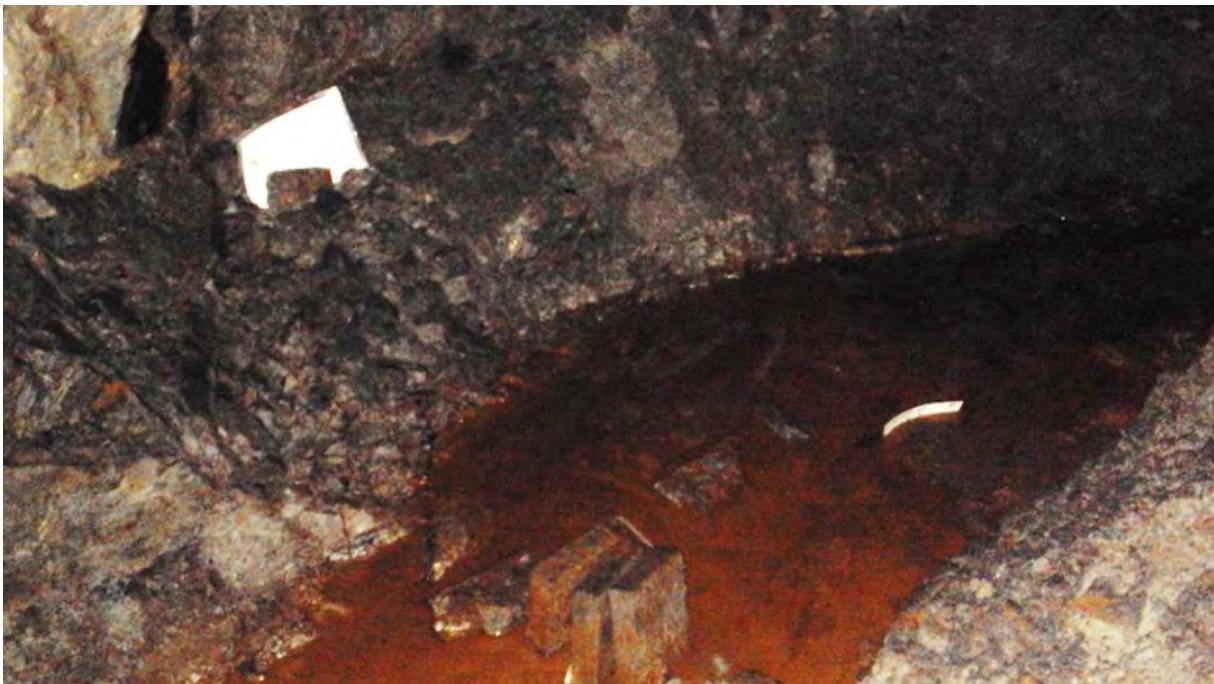
V12.12. Grøft B i mars 2017. Merk høgare vasstand enn i 2012, typisk for mesteparten av eksponeringstida fram til september 2015. Bildet viser dei tre siste plateprøvene (alle tre reseptar) for vidare eksponering. Foto: Per Hagelia.
