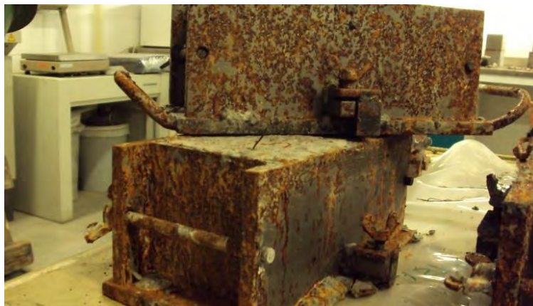
Figur 7: Terningane blei ståande i formene ute i tunnelen og eksponert for tunnelluft i tre veker. Tunnellufta er ekstremt korrosiv og førte til at formene måtte kasserast etter avforming i laboratoriet. Foto: Per Hagelia.
