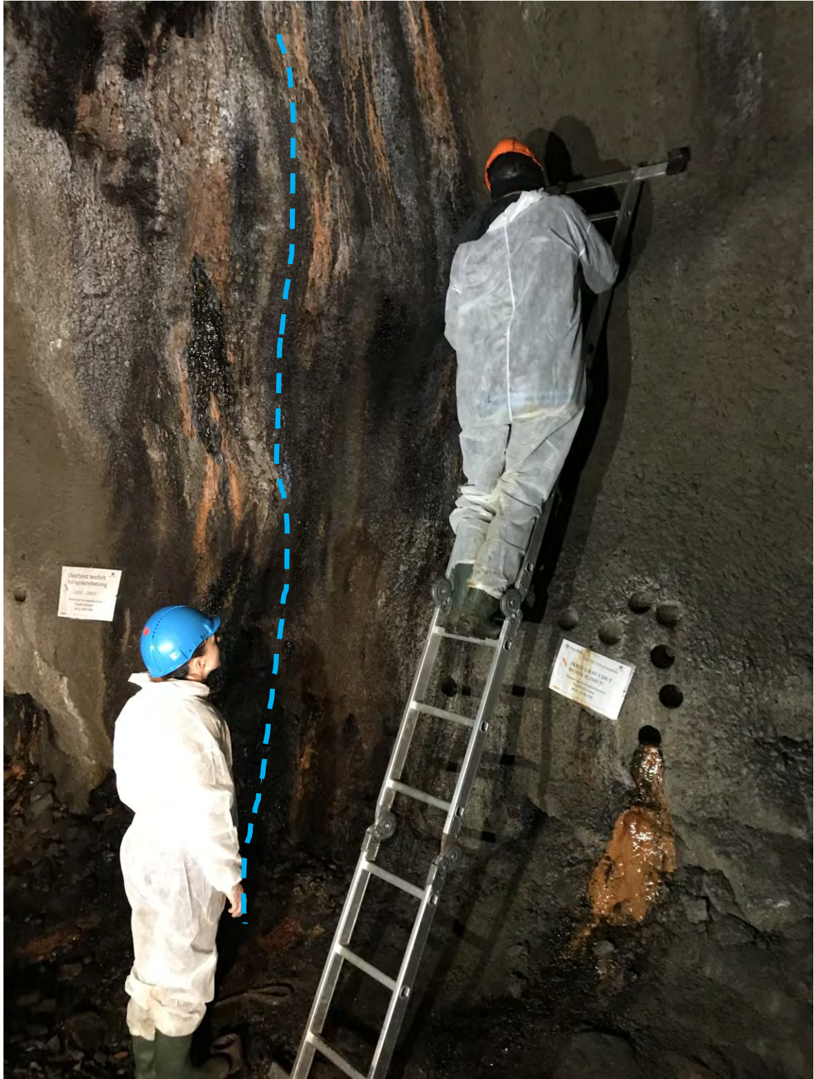
V12.7. Felt 1 og Felt 2 i september 2020 med prøvetaking av biofilm. PhD kandidat Sabina Karačić og Frank Persson i stigen. Grensa mot Felt 2 er merka omtrentleg med stipla linje. Merk at biofilmen var blitt mørkare med mindre innslag av rust. Biofilmen hadde omkring 2018 fått eit tørrare ytre preg enn tidlegare år, men var våt straks under ytterflata mot sprøytebetongen. Områder med kjerneuttak er vist i Vedlegg 6 og Vedlegg 13. Foto: Per Hagelia.
