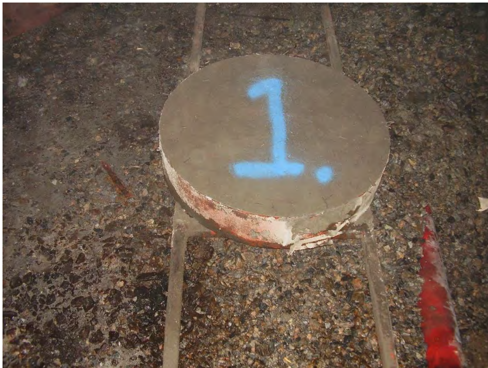
V4.3. Ferdig plateprøve av sprøytebetong for langtidseksponering i grøftevatn og testing av energiabsorpsjon. Foto: Reidar Kompen.
