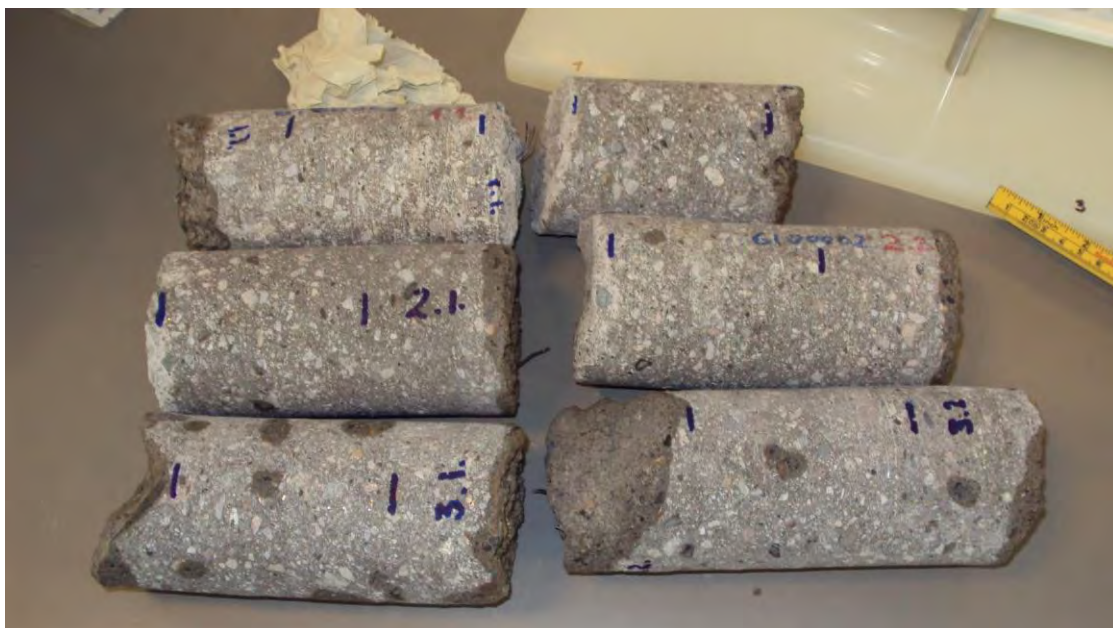
V6.5. Sylinderar ( \phi = 75 mm) av sprøytebetong frå Felt 1, Felt 2 og Felt 3 for betonganalyse. Foto: Per Hagelia.
