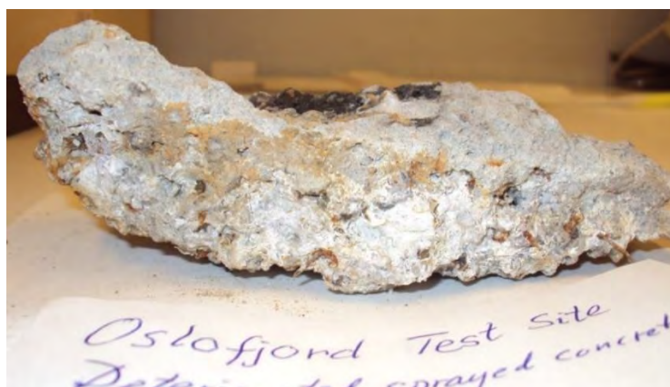
Figur 4: Prøve av ytre avskala sprøytebetong frå 2010 før testfeltet blei etablert: Øvst: Omdanna og svak sprøytebetong under biofilm med utfelling av manganoksid (svart) og jernoksid (brunt) langs indre brotflate: ytterflata vender ned. Lys betong er kraftig karbonatisert med utfelling av kvite flekker av magnesium hydroksid (brucitt); destruktiv fiberkorrosjon (lysbrune flekker) og teikn på sulfatangrep. Nedst: Tverrsnitt av same prøva viser nedbryting og svekking av tverrsnittet (4–5 cm). Betongalder 11 år. Foto: Per Hagelia.
