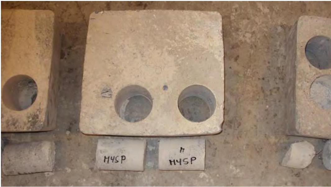
V6.11. Sylindrar ( \Phi = 75 \text{ mm} ) bora ut frå karprøver for analyse av utgangsegenskapar. Resept 2 (M45P) tilsvarande sprøytebetongen i Felt 2. Foto: Per Hagelia.
