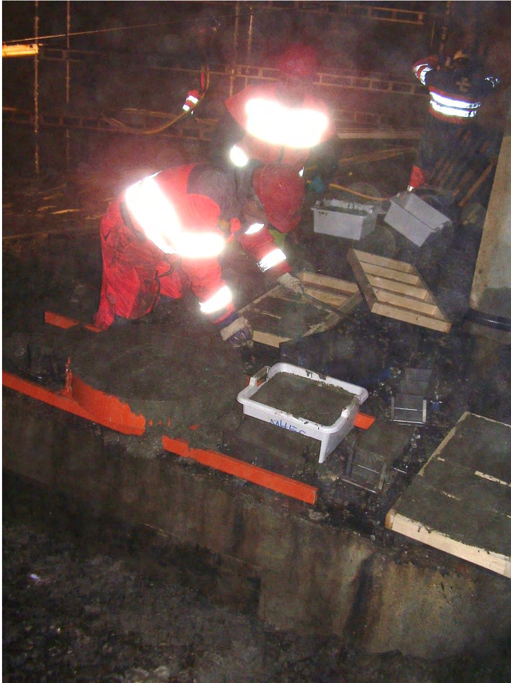
V4.4. Det blei støyt ut testprøver av alle tre reseptar for eksponering i tunnelmiljøet: i) plate (Ø600 x 100 mm) for energiabsorpsjon (nærmast), ii) store prøver støypte i plastkar for utboring av sylindrar, iii) plateprøver (325 x 154 x 48 mm) støyt ut i treformer og iv) terningar (100 x 100 x 100 mm) støypte i stålformer. Foto: Reidar Kompen.
