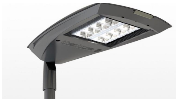
Figur 4: Typisk veglysbarmatur med lysdioder og reflektorer rundt hver diode og et flatt glass under disse. Dette er en typisk løsning for en LED veglysbarmatur med reflektorer, men noe mindre brukt en armaturer med linser. Foto: AEC Illumazione
