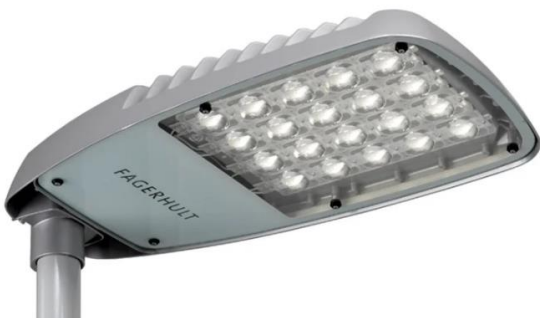
Figur 3: Typisk veglysbarmatur med lysdioder og linse over hver diode og et flatt glass under lensene. Dette er en typisk løsning for en LED veglysbarmatur. Foto: Fagerhult
