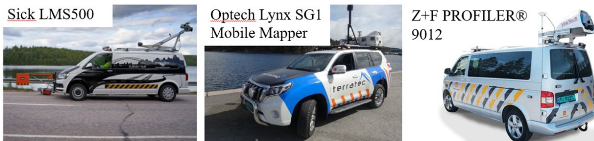
Figur 3: Målebiler med laserskannere [3,4, Statens vegvesen]
