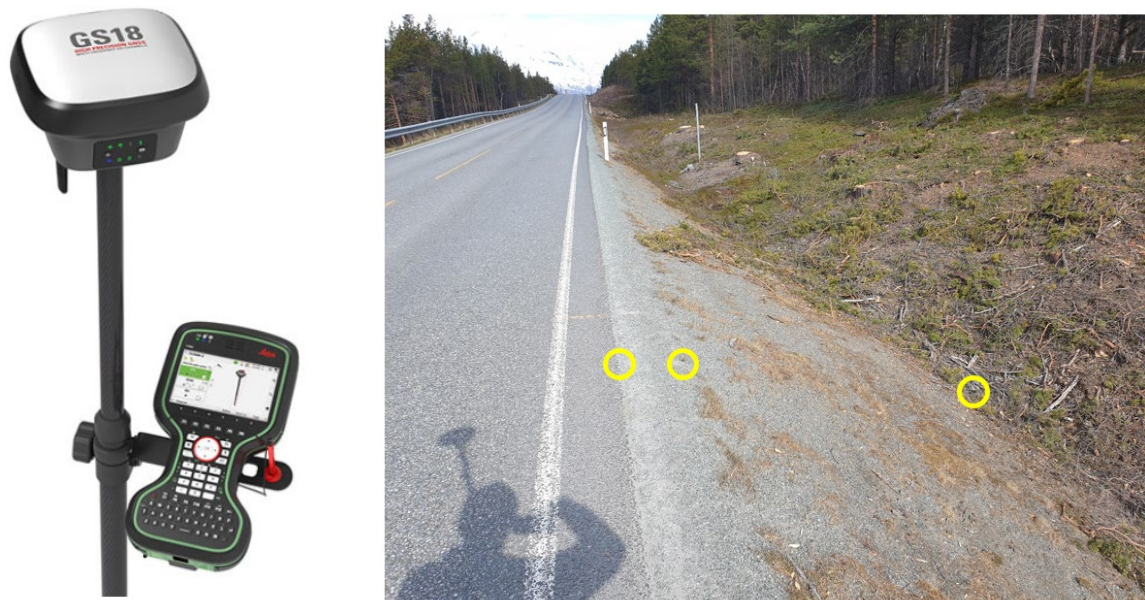
Figur 4: Leica GS18 [14] (t.v) og illustrasjon av innmålte punkter [Statens vegvesen] (t.h.)
