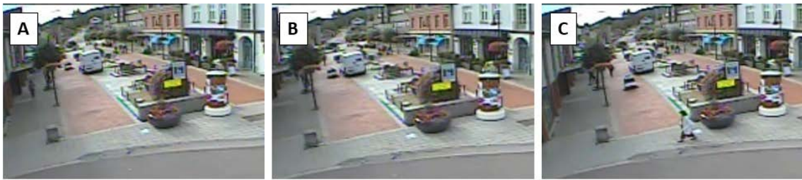
Figur 16: Uvanlig interaksjon med bil: (A) Driftsmaskin kjører i sin vanlige rute. (B) Driftsmaskinen registrerer en parkert varebil på siden av ruten, sakter og stopper. (C) Etter en stund fortsetter driftsmaskinen igjen å kjøre.
