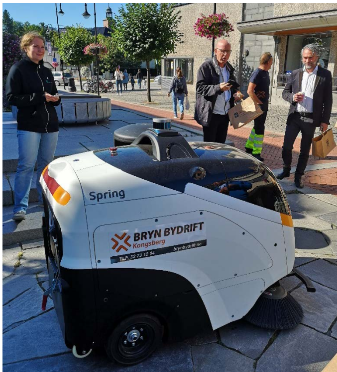
Figur 1: Den selvgående kostemaskinen Spring S1 i gågata på Kongsberg. Foto fra demonstrasjon 25. august 2020. Foto: Torkel Bjørnskau
