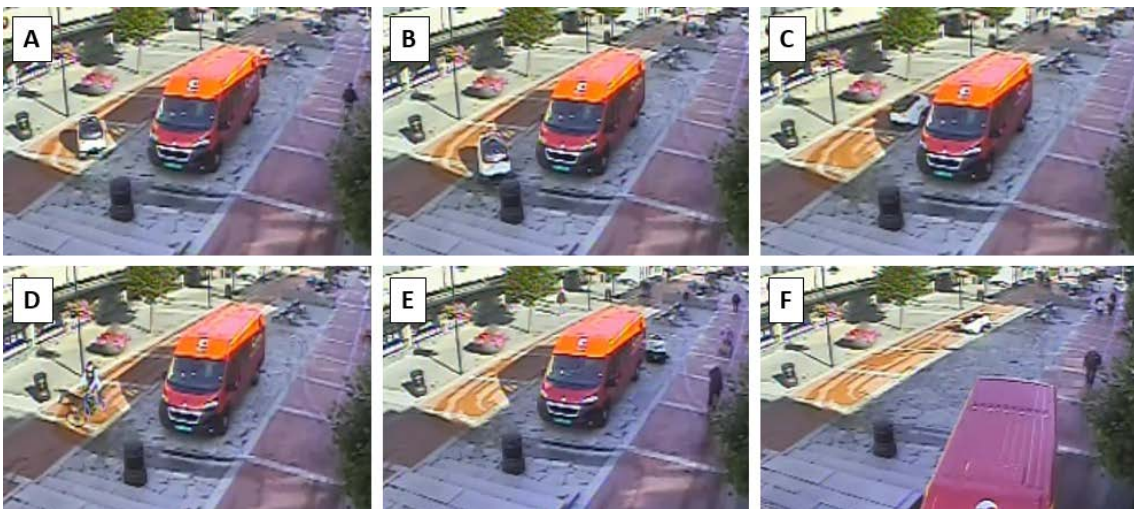
Figur 17: Uvanlig interaksjon med bil: (A) Driftsmaskin kjører i sin vanlige rute, den registrerer varebilen som er i veien, maskinen sakter og stopper. (B) Driftsmaskinen forsøker å passere varebilen. (C) Driftsmaskin gir opp og rygger. (D) Driftsmaskinen stopper. (E) Driftsmaskin rygger videre rundt varebilen og stanser og kjører bort fra varebilen. (F) Varebilen kjører og driftsmaskin fortsetter sin vanlige rute.
