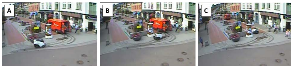
Figur 15: Vanlig interaksjon med bil. (A) Driftsmaskin kjører langs sin rute, (B) Maskinen oppdager bilen foran, sakker og stopper, (C) Bilen er ikke lenger i veien, og maskinen fortsetter.
