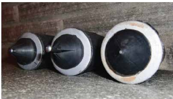
Figur 6.13 Til venstre pakkere med stift i spissen av enveisventilen. Pakker med gummimansjett fremfor krysskåret spiss som her har ikke denne muligheten. (Foto [70]) Til høyre eksempel på markering av hullkontakter under injeksjon i Storhaugtunnelen i Stavanger.
