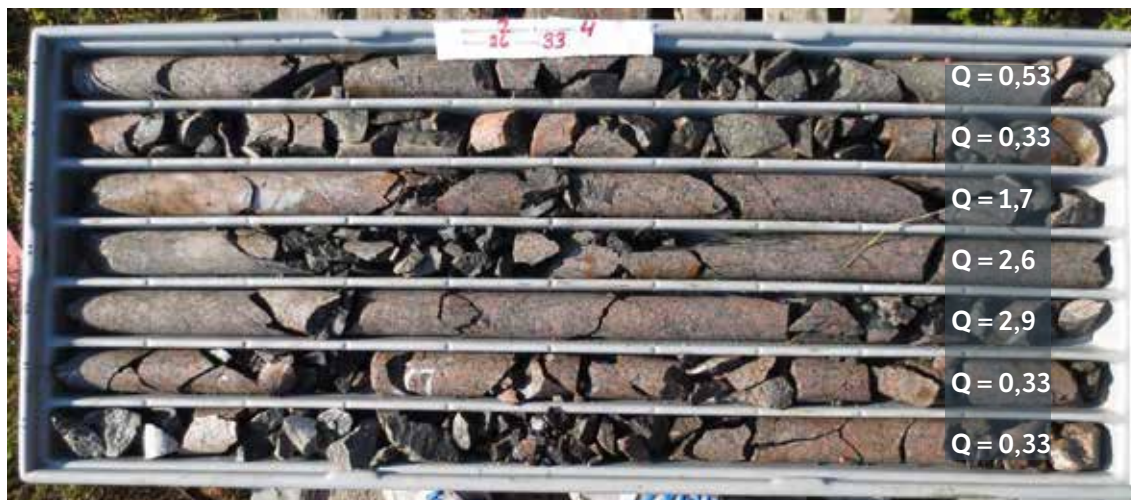
Figur 2.3 Bilde av borkjerner fra Bjarkøy. Bildet viser oppknust og forvitret granittisk gneis. Q-verdi pr bormeter er vist til høyre i bildet. (Foto: Edvard Iversen)
