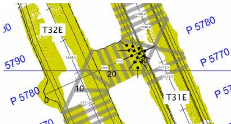
Figur 6.37 Eksempel med tung sikring i form av armerte sprøytebetongbuer for en bred svakhetszone som skjærer tunnelene gjennom et utvidet tverrslag. Gyste bolter i en av trekantene er vist med ansett og stikning. Lyshorntunnelen på E39 Os-Bergen. Foto av buene er vist figur 6.38.
