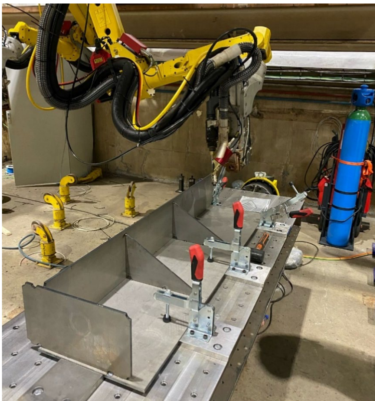
Figur 21 Prefabrikasjon av kassetter
