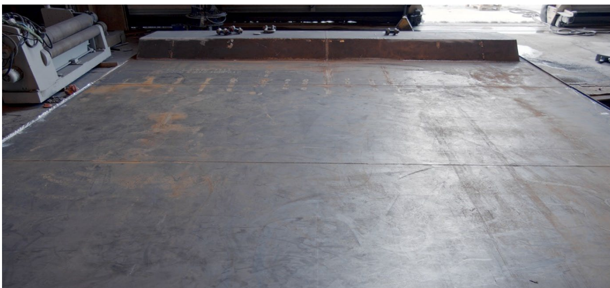
Figur 38 Dekksflate sveist med laser uten etterbehandling med varme
