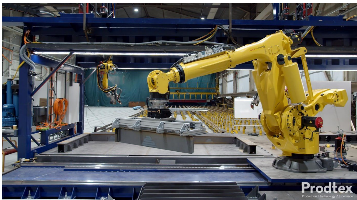
Figur 23 Montering av kassetter med robot
