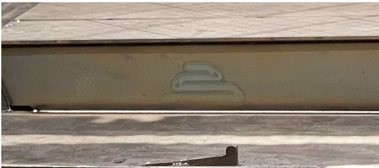
Figur 37 Laser Hybrid sveis med full gjennombrenning
