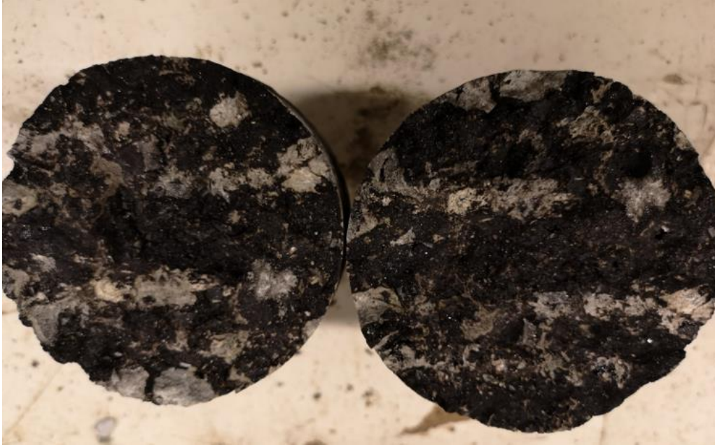
Figur 3.3: Delt kjerne fra E6 Øyjord (frest underlag)
