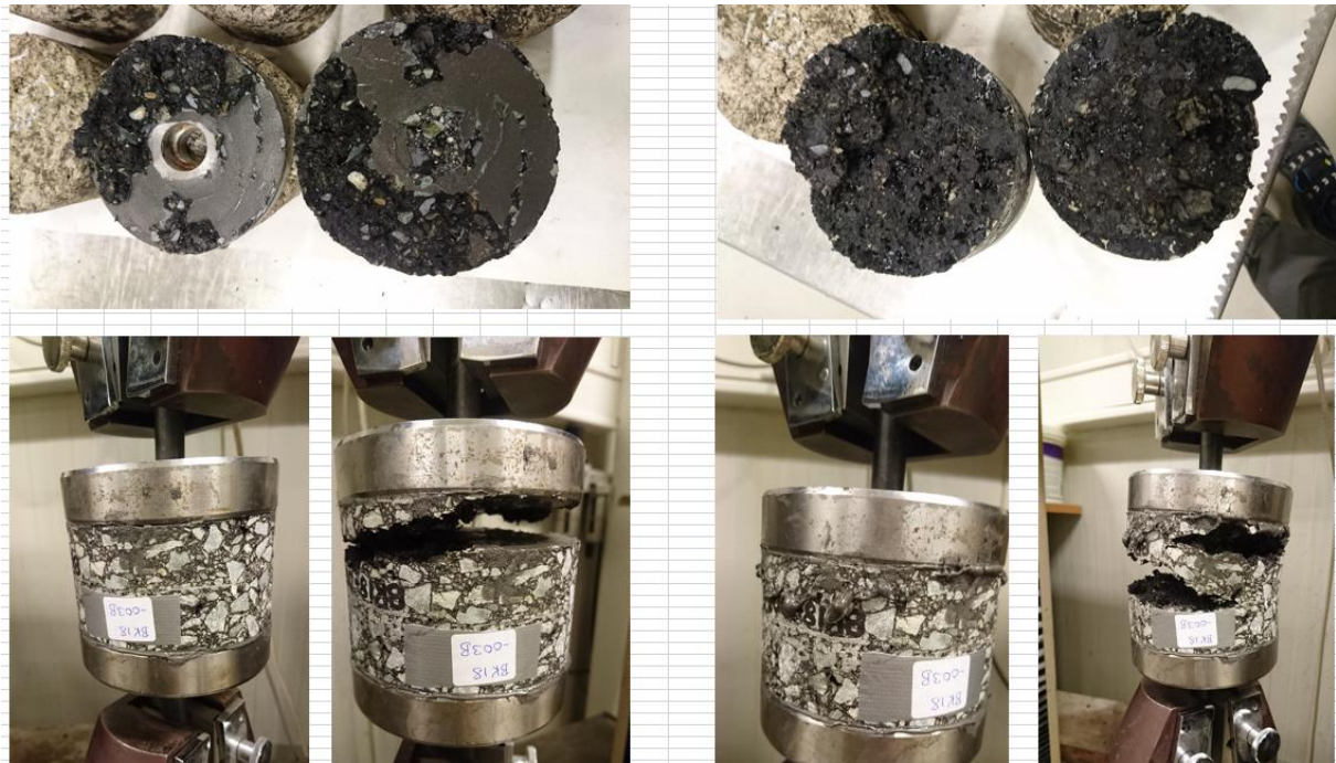
Figur 3.1: Observasjoner fra testing av bindingsstyrke
