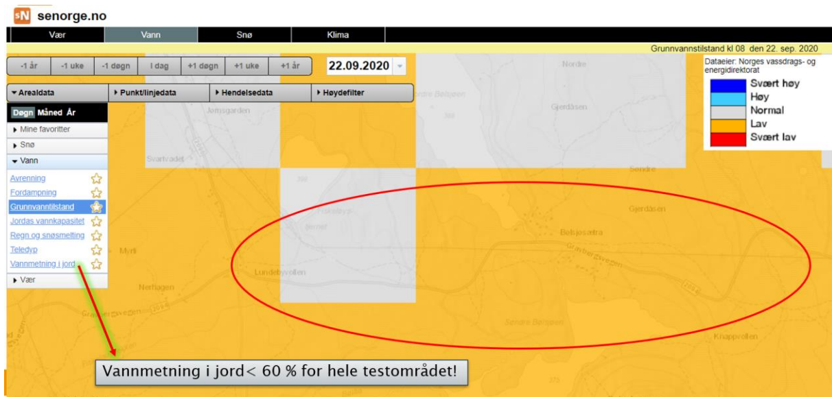
Figur 28 Grunnvannsnivå under belastningsforsøket. Kilde: www.senorge.no .
