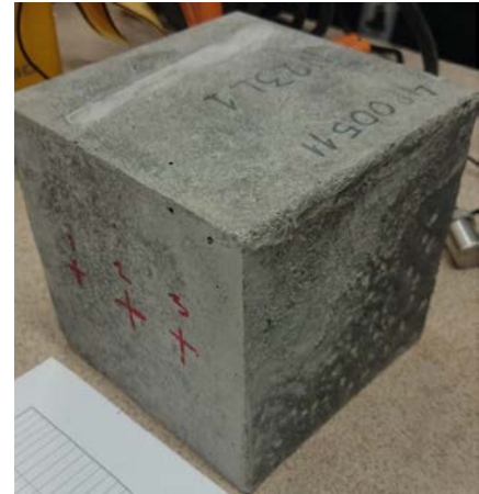
Lab.prøve for ultralydprøving. Hel terning
