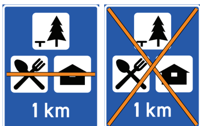
Figur 5-1.4 Bruk av teip for å varsle at noen eller alle tilbud er stengt
