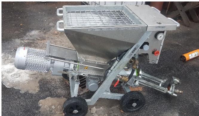
Figur 12 Pumpa som ble brukt til å blande sement og vann og pumpe dette gjennom totalsonderingsstenger og inn i sleppa, som var den antatte kilden til lekkasjen.
