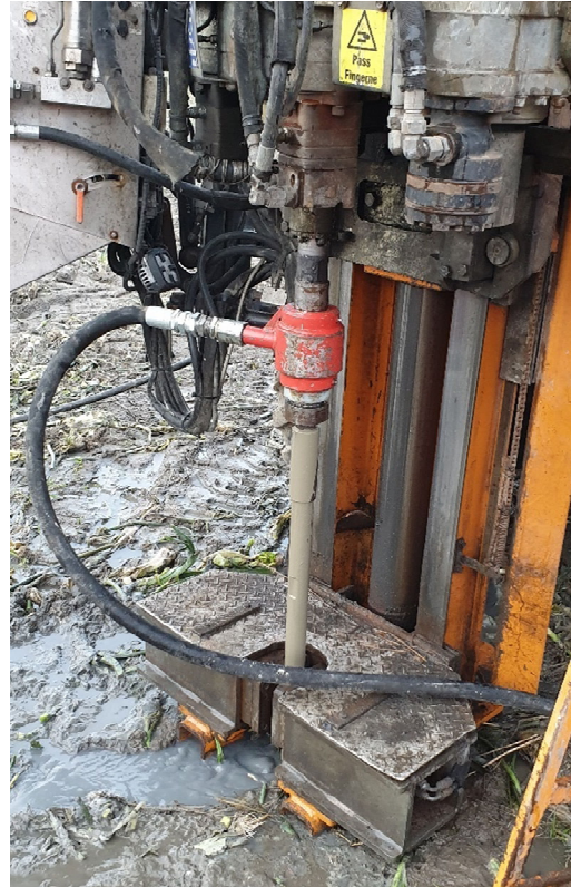
Figur 5 Adapter for å koble slange fra betongpumpe på totalsondering-borstenger (R32-gjenger).
