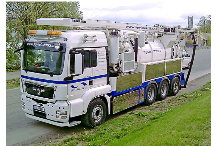
Spyle og sugebil til fjerning av slam. Spyleteknikk.no
