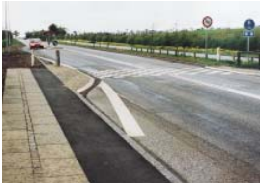
Figur 32 Overgang mellom ensidig og tosidig sykkelsti Danmark (4)
