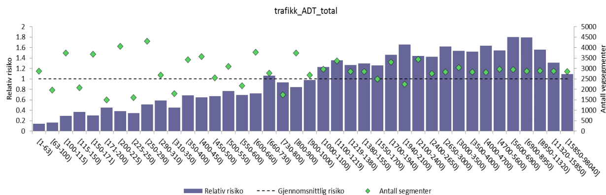
Figur 1 Eksempel på plott av relativ risiko for variabelen «trafikk_ADT_total» som ble benyttet til å avgjøre hvilken øvre og nedre grense for ÅDT som skulle begrense utvalget av vegsegmenter til analysen.
