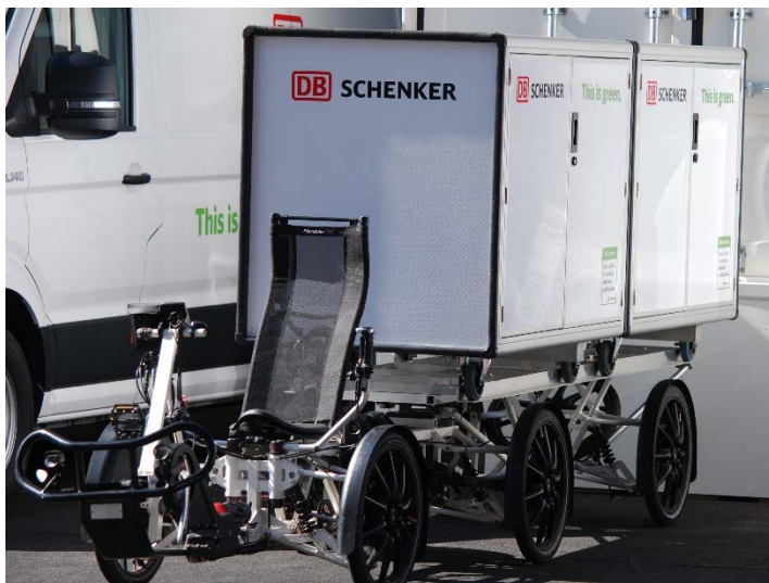
Figur 5.1: Den elektriske lastesykkelen som DB Schenker benytter til sine leveranser. Foto: Olav Eidhammer
