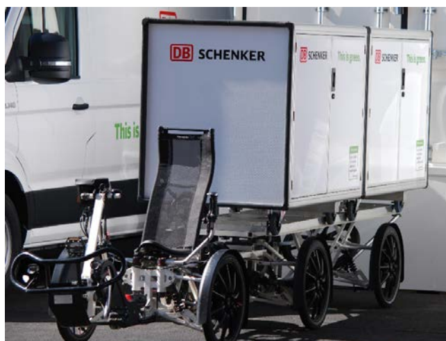
Figur 6.1: Den elektriske lastesykkelen som DB Schenker benytter til sine leveranser. Foto: Olav Eidhammer
