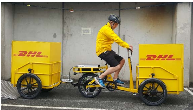
Figur 4.1: En av to elektriske lastesykler som DHL Express benytter i sine leveranser. Batteriet er plassert bak på lastesykkelen. Hentet fra Ørving mfl. (2018).
