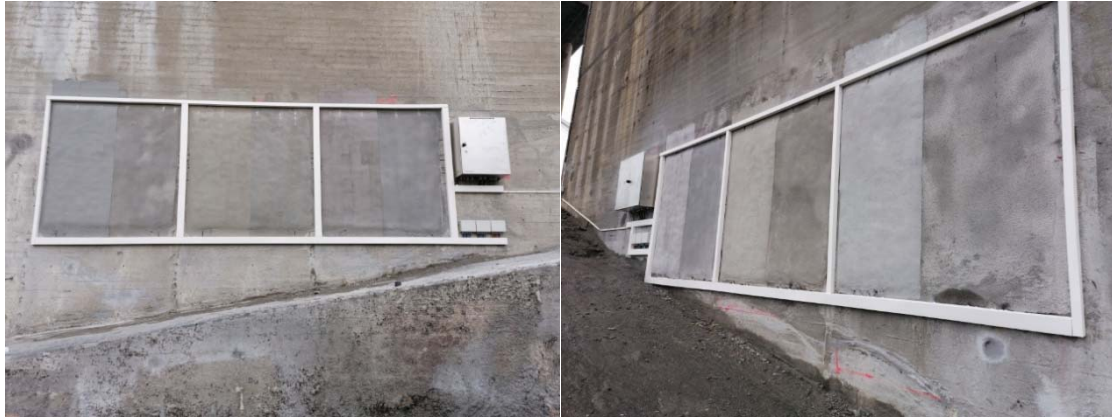
Figur 17 - Prøvefeltene med overflatebehandling, venstre - sørside, høyre - nordside.
